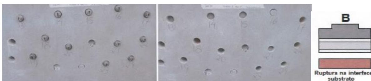
Figura 5 – Ensaio de arrancamento sistema tradicional (Fonte: os autores)
