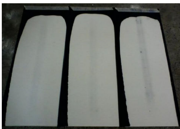
Tinta pura: 1º ensaio Tinta pura: 2º ensaio Tinta pura: 3º ensaio Figura 12: Três amostras de tinta pura, após a realização dos ensaios.
