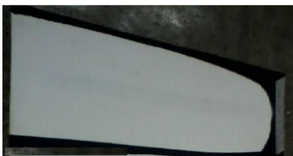
Figura 9: Corpo-de-prova com a amostra de tinta, com adição de 15% de massa acrílica.
