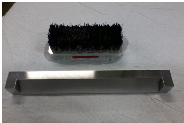
Figura 3: Escova de nylon e suporte para escova com calço de borracha.
