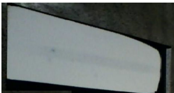
Figura 8: Corpo-de-prova com a amostra de tinta, com adição de 10% de massa acrílica.
