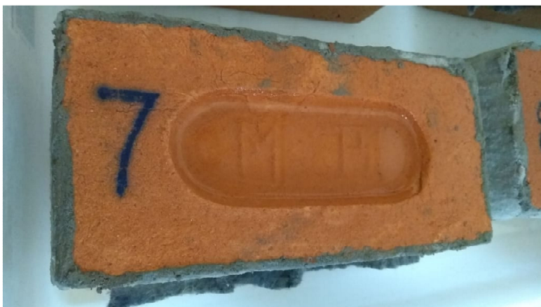
Figura 12. Lâmina d'água no rebaixo Fonte: acervo próprio
