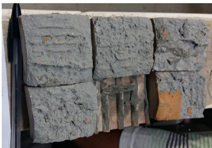
Figura 42: Ensaio 2 - Formas de ruptura dos revestimentos cerâmicos 60x60 cm sem o uso da argamassa impermeabilizante Fonte: Autora (2017)
