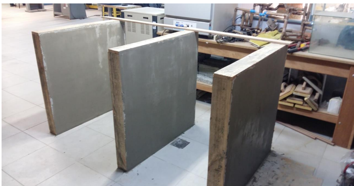
Figura 18: Argamassa impermeabilizante aplicada em apenas uma face de cada parede teste Fonte: Autora (2017)
