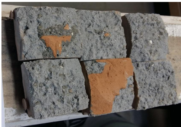
Figura 41: Ensaio 2 - Formas de ruptura dos revestimentos cerâmicos 30x30 cm com o uso da argamassa impermeabilizante Fonte: Autora (2017)
