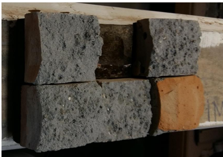
Figura 35: Ensaio 1 - Formas de ruptura dos revestimentos cerâmicos 30x30 cm com o uso da argamassa impermeabilizante Fonte: Autora (2017)
