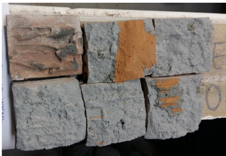
Figura 36: Ensaio 1 - Formas de ruptura dos revestimentos cerâmicos 60x60 cm sem o uso da argamassa impermeabilizante Fonte: Autora (2017)
