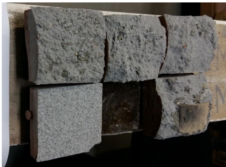
Figura 37: Ensaio 1 - Formas de ruptura dos revestimentos cerâmicos 60x60 cm com o uso da argamassa impermeabilizante Fonte: Autora (2017)
