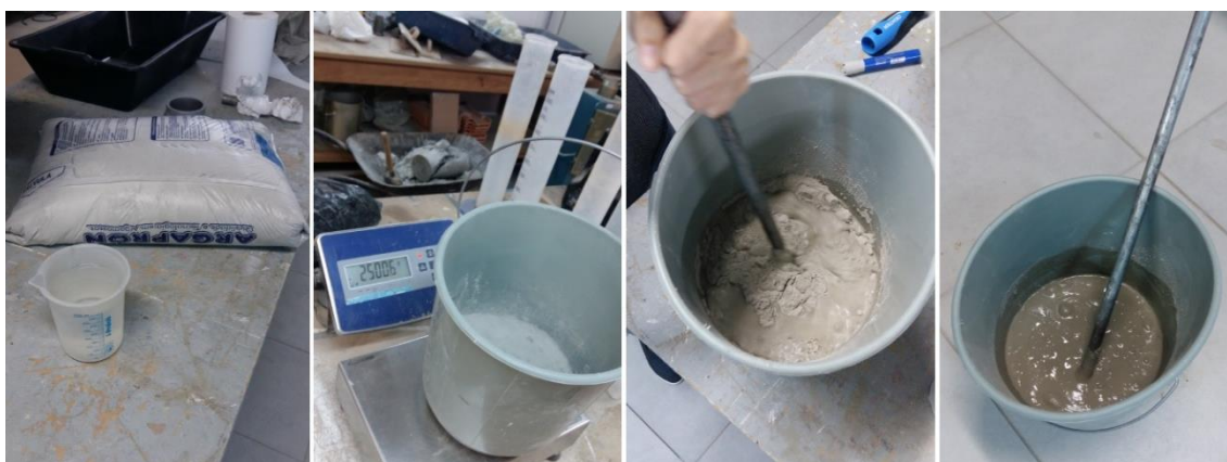
Figura 16: Preparo da argamassa impermeabilizante Fonte: Autora (2017)
