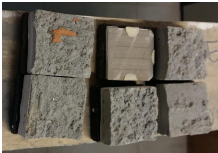
Figura 39: Ensaio 2 - Formas de ruptura dos revestimentos cerâmicos 5x5 cm com o uso da argamassa impermeabilizante Fonte: Autora (2017)
