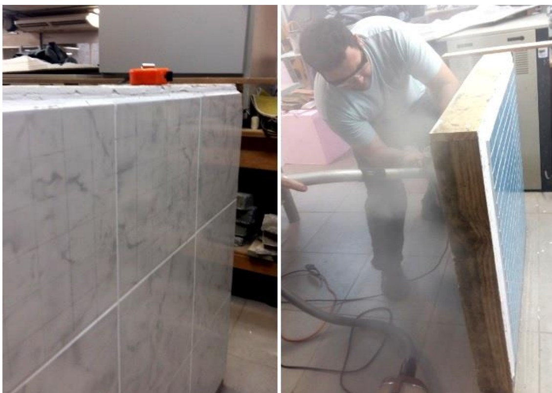
Figura 25: Marcação e realização dos cortes dos corpos de prova Fonte: Autora (2017)
