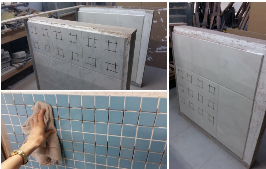
Figura 26: Limpeza das faces das paredes após a realização dos cortes dos corpos de prova Fonte: Autora (2017)
