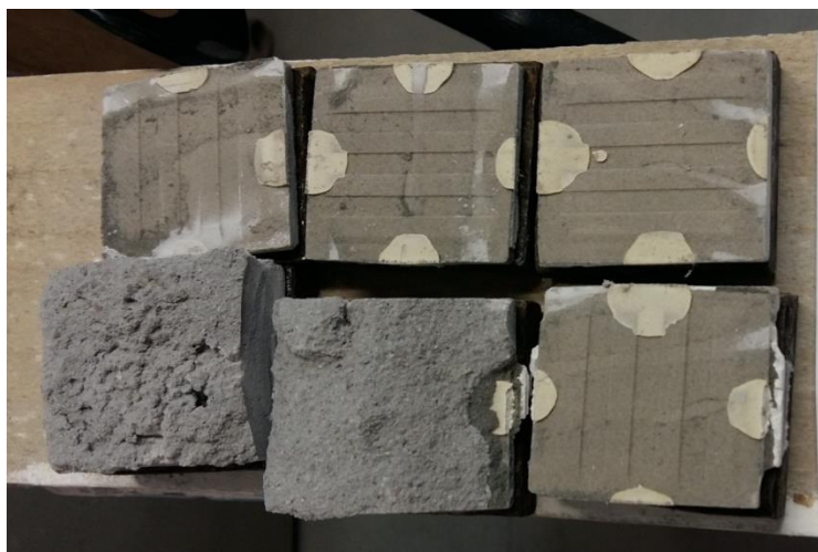
Figura 32: Ensaio 1 - Formas de ruptura dos revestimentos cerâmicos 5x5 cm sem o uso da argamassa impermeabilizante Fonte: Autora (2017)
