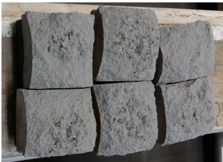
Figura 40: Ensaio 2 - Formas de ruptura dos revestimentos cerâmicos 30x30 cm sem o uso da argamassa impermeabilizante
