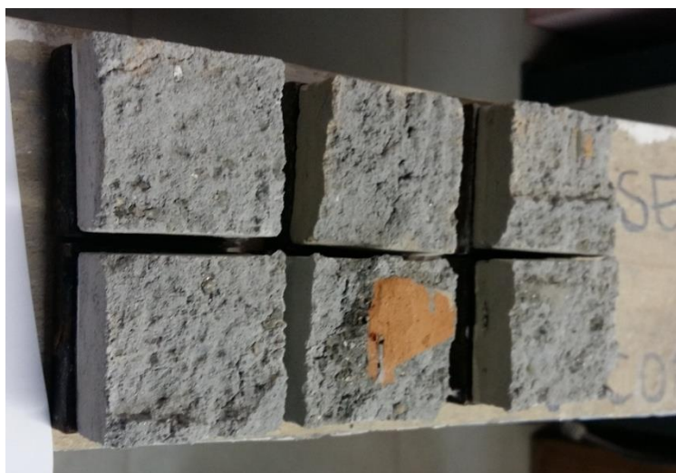
Figura 33: Ensaio 1 - Formas de ruptura dos revestimentos cerâmicos 5x5 cm com o uso da argamassa impermeabilizante
