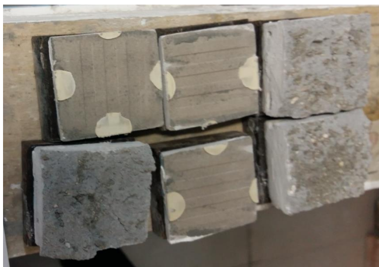
Figura 38: Ensaio 2 - Formas de ruptura dos revestimentos cerâmicos 5x5 cm sem o uso da argamassa impermeabilizante
