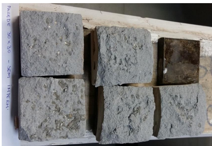
Figura 34: Ensaio 1 - Formas de ruptura dos revestimentos cerâmicos 30x30 cm sem o uso da argamassa impermeabilizante
