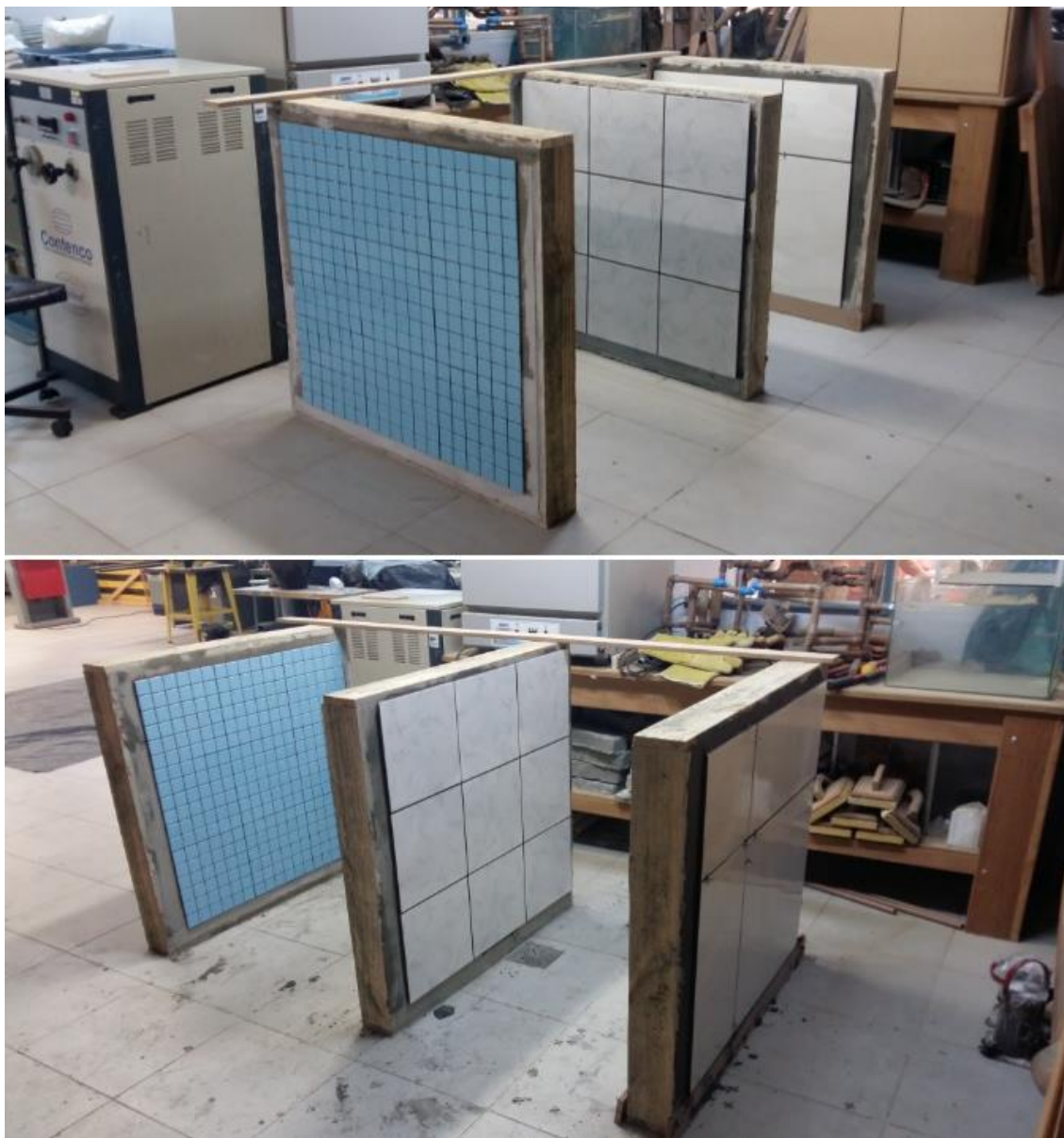
Figura 22: Aplicação finalizada dos revestimentos cerâmicos nas paredes testes Fonte: Autora (2017)
