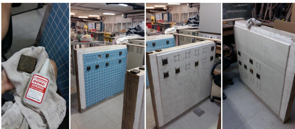
Figura 27: Colagem das peças metálicas com a utilização de adesivo instantâneo Fonte: Autora (2017)
