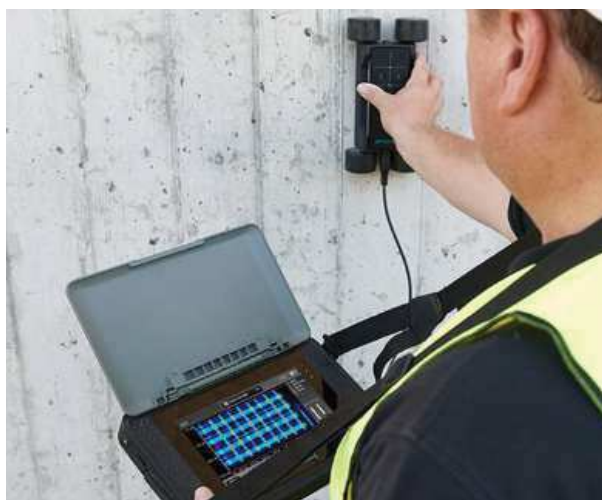
Figura 3: Detector Eletromagnético de Armadura da marca Proceq ( www.proceq.com.br )
