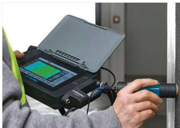
Figura 4: Equipamento de medição de Potencial de Corrosão – Profometer Corrosion da Proceq ( www.proceq.com )
