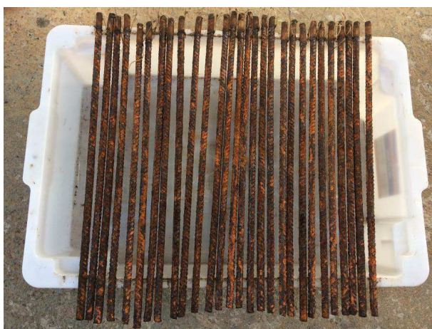
Figura 8: Aspecto das amostras na retirada, após 168h de exposição à névoa salina.
