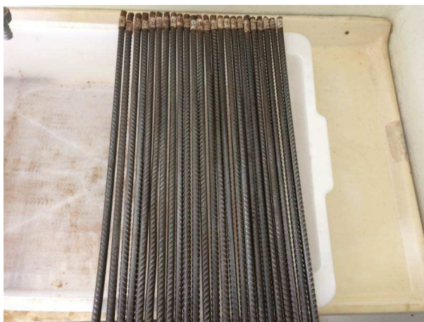
Figura 6: Barras de aço após realização da limpeza com escova de aço e acetona.
