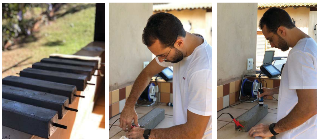
Figura 12: Realização do Ensaio de Potencial de Corrosão das Armaduras.
