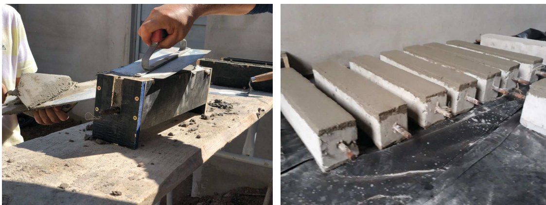
Figura 11: Aplicação da camada de argamassa.
