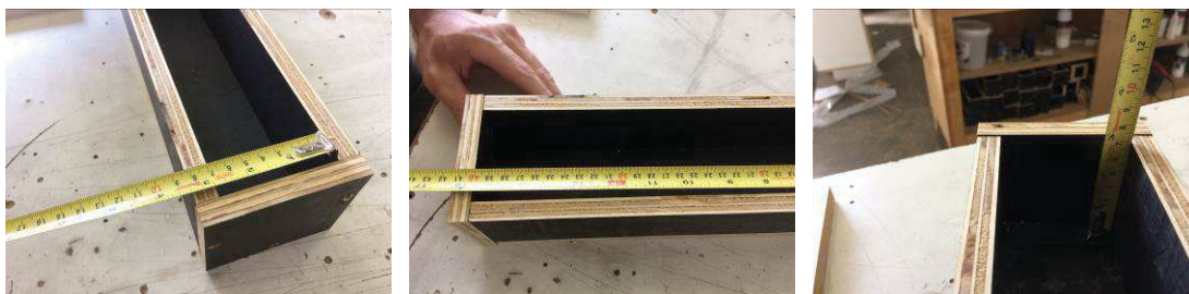
Figura 9: Formas em madeira para moldagem de corpos de prova prismáticos.
