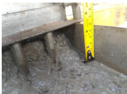
Figura 8: Aspecto do concreto com substituição de cimento por metacaulim em 3%. (Autor)
