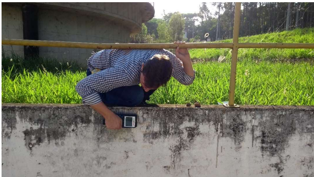
Figura 18 – Pacometria para demarcação das posições
