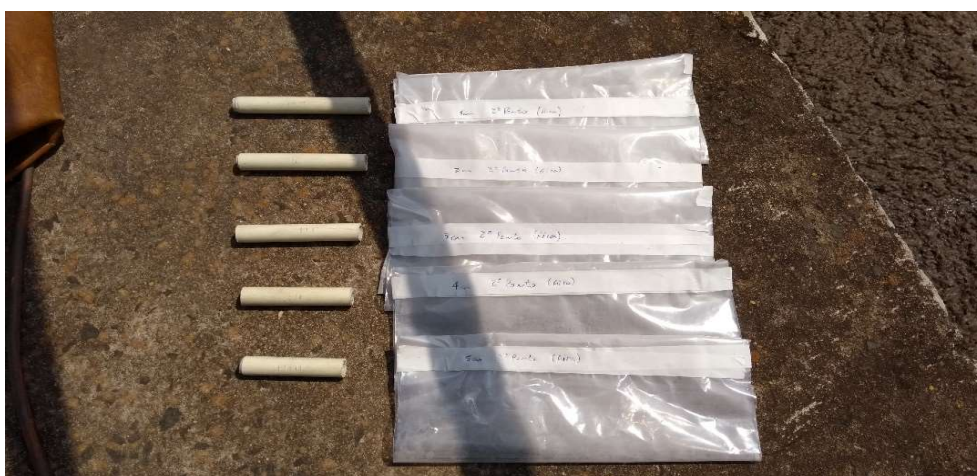
Figura 27 – Amostras extraídas da estrutura dos Aeradores
