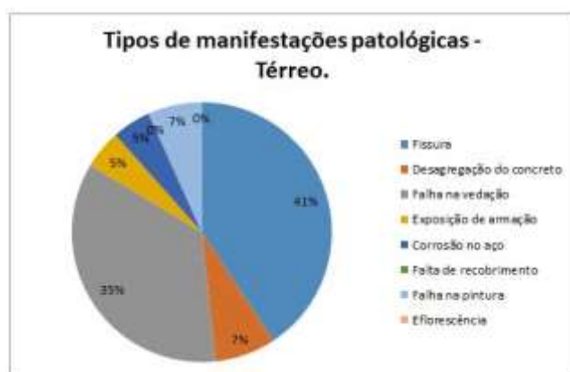
Gráfico 2: Manifestações patológicas identificadas em piso e pilares do pavimento térreo
