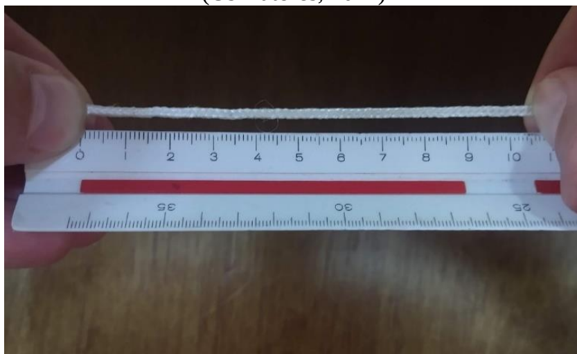
Figura 16. Medição do comprimento de cada uma das fissuras dos painéis protótipos (Os Autores, 2021)
