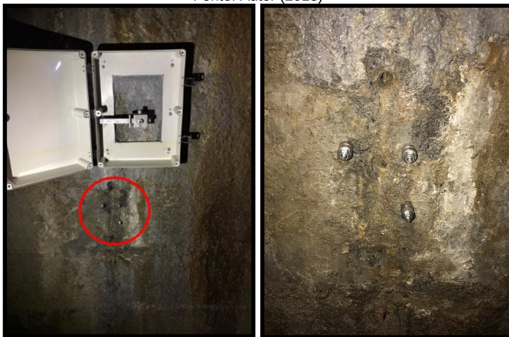
Figura 14 – Posicionamento do medidor triortogonal e dos pinos de aço.
