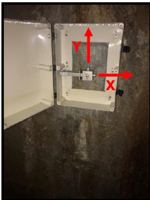
Figura 5 - Orientação do eixos do medidor triortogonal Fonte: Autor (2018).
