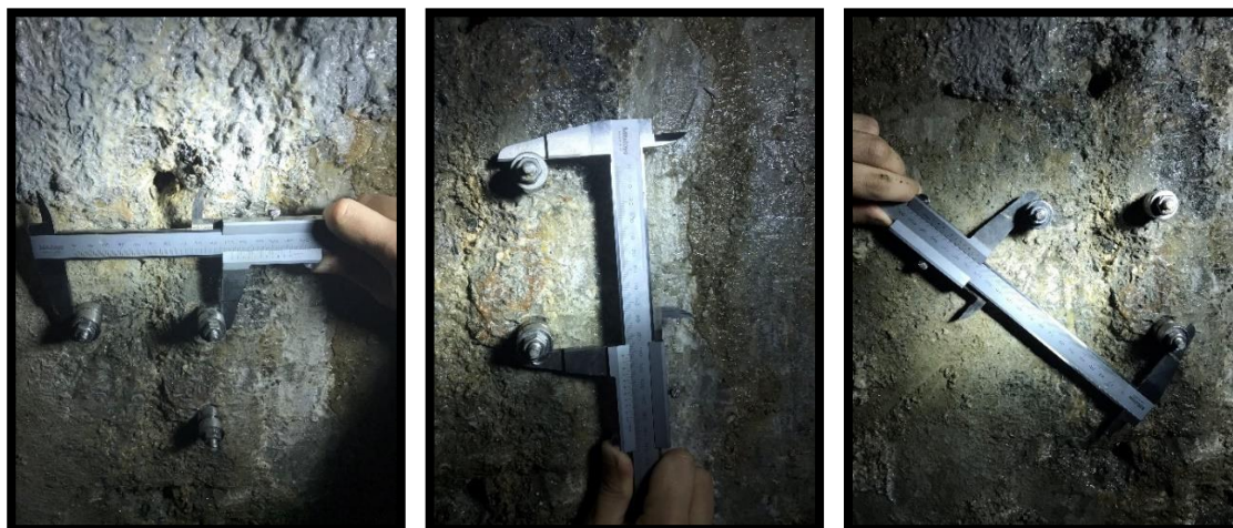
Figura 15 – Medições realizadas no equipamento dos “Três Pinos” com auxílio de um paquímetro.
