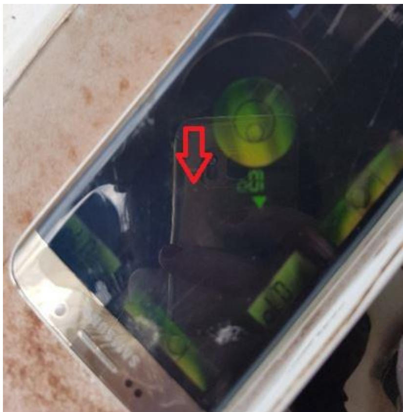
Figura 17. Inclinação inadequada da soleira
