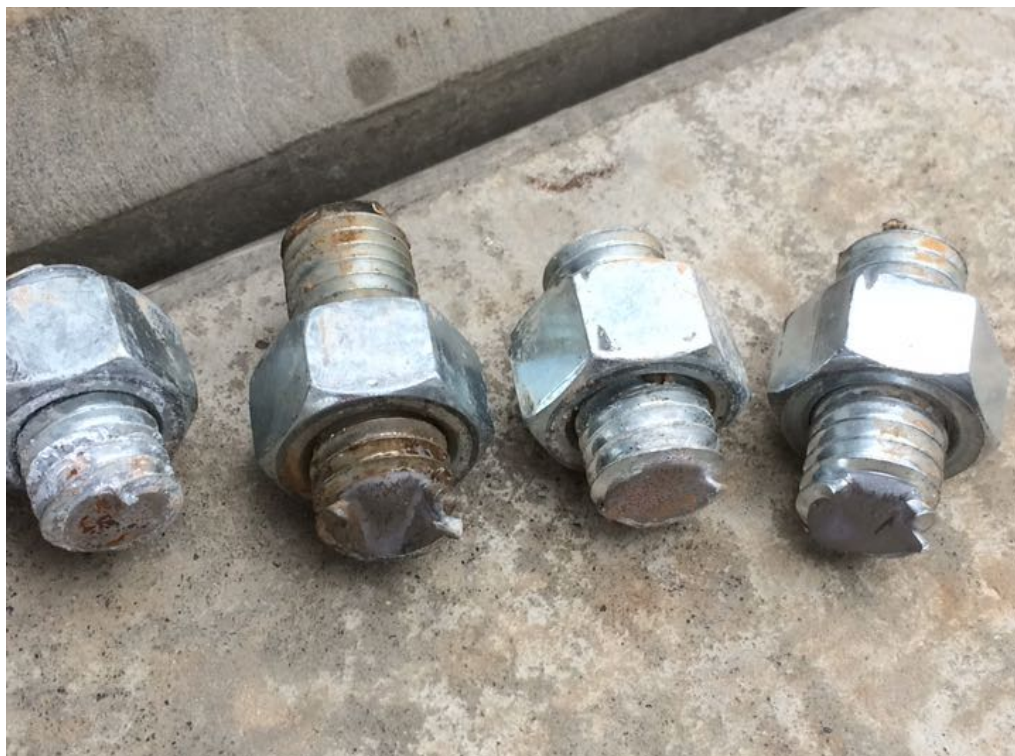
Figura 21– Parafusos cisalhados devido ao mal dimensionamento e especificação de projeto e/ou má qualidade do material adquirido.
