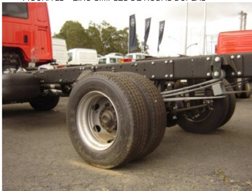
FIGURA 12 – EIXO SIMPLES DE RODAS DUPLAS
