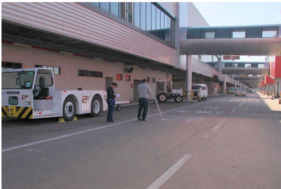
FIGURA 32 – REGISTRO DA MEDIDA DA FLECHA NA TRILHA DE RODA NO SUBTRECHO FLEXS 101
