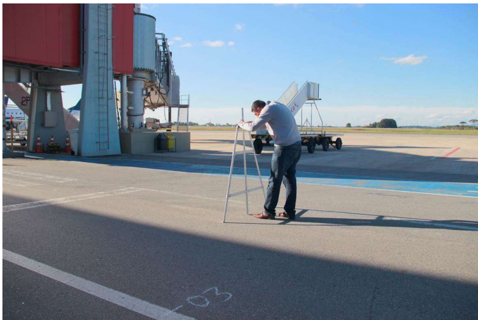
FIGURA 22 – LEITURA DA MEDIDA DA FLECHA NA TRILHA DE RODA EXTERNA
