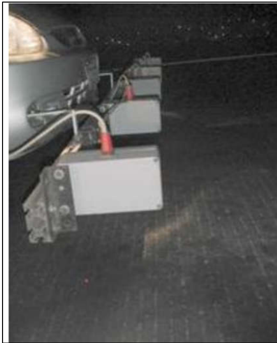
FIGURA 27 – APARELHO BARRA A LASER ACOPLADO A VEÍCULO
