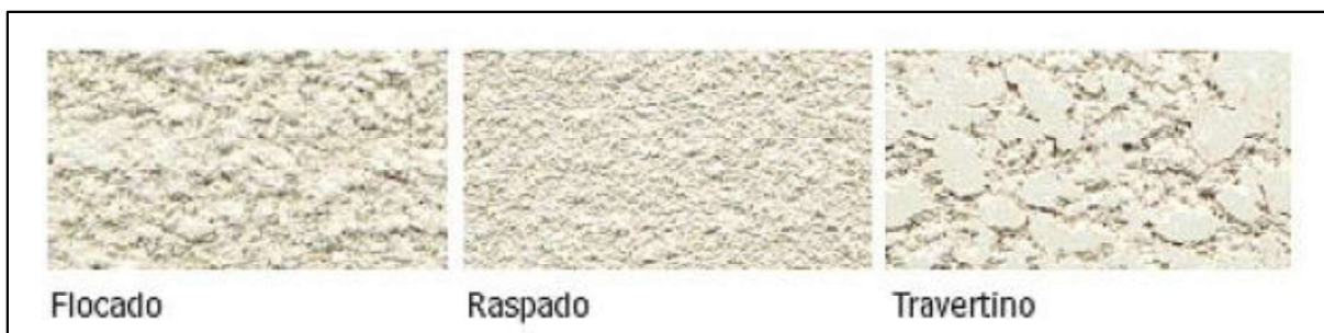
Figura 4. Tipos de acabamento de revestimento monocamada (Silva, 2010)
