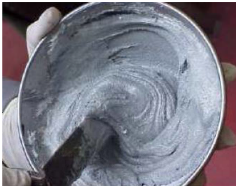
Figura 7 – Mistura da resina epóxi com a consistência homogênea desejada (SOUZA, 2008).
