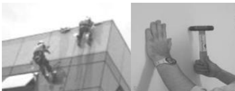
Figura 5 - Exemplificação do teste de percussão em fachada
