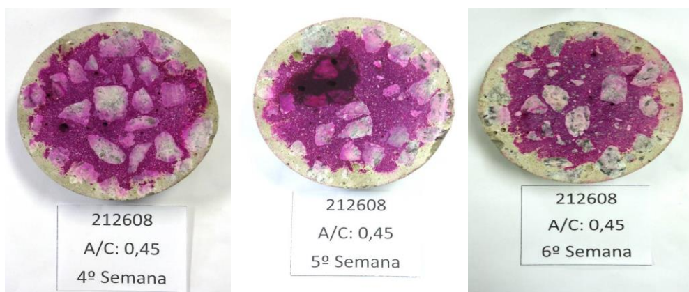
Figura 13 – Evolução da Frente de Carbonatação. 4ª, 5ª e 6ª semana, A/C 0,45.
