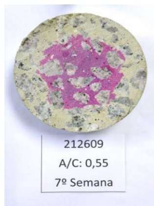
Figura 17 – Evolução da Frente de Carbonatação. 7ª semana, A/C 0,55.
