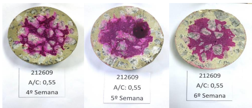
Figura 16 – Evolução da Frente de Carbonatação. 4ª, 5ª e 6ª semana, A/C 0,55.
