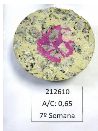
Figura 20 – Evolução da Frente de Carbonatação. 7ª Semana, A/C 0,65.
