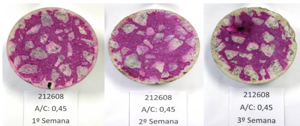
Figura 12 – Evolução da Frente de Carbonatação. 1ª, 2ª e 3ª semana, A/C 0,45.
