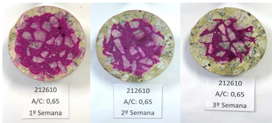
Figura 18 – Evolução da Frente de Carbonatação. 1ª, 2ª e 3ª semana, A/C 0,65.
