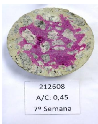
Figura 14 – Evolução da Frente de Carbonatação. 7ª semana, A/C 0,45.
