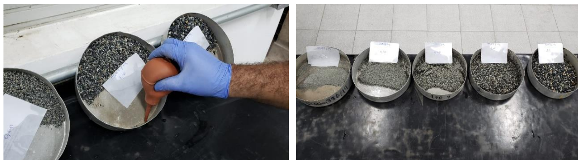
Figura 19 - Remoção do excesso de água com sugador manual (acervo próprio, 2019).
