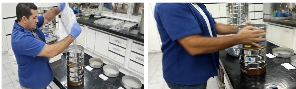
Figura 16 - Processo de peneiramento manual do material (acervo próprio, 2019).
