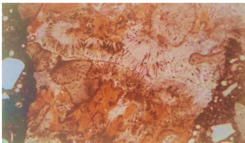
Figura 11- Detalhe de lâmina petrográfica, mostrando agregado contendo calcedônia reativa (sílica criptocristalina) (SBRIGHI NETO; QUITETE; BATTAGIN, 2018).
