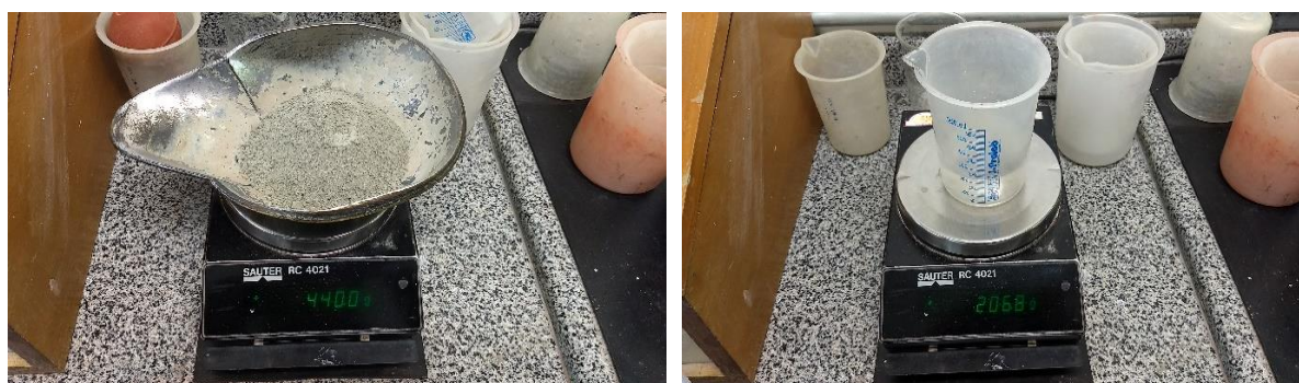
Figura 21 - Pesagem do cimento-padrão e água deionizada em balança de precisão (acervo próprio, 2019).
