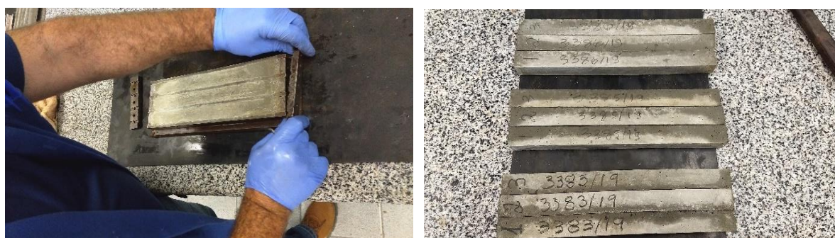
Figura 26 – Procedimento de desforma e identificação do IPT nas barras de argamassa (acervo próprio, 2019).
