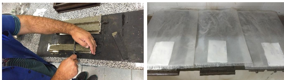
Figura 25 – Procedimento de rasamento/nivelamento da superfície das barras de argamassa e cura inicial em câmara úmida (acervo próprio, 2019).
