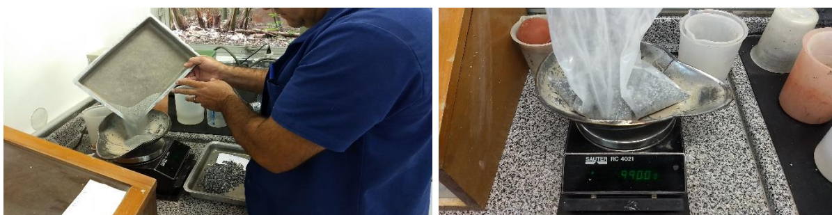
Figura 22 - Pesagem dos agregados em balança de precisão (acervo próprio, 2019).
