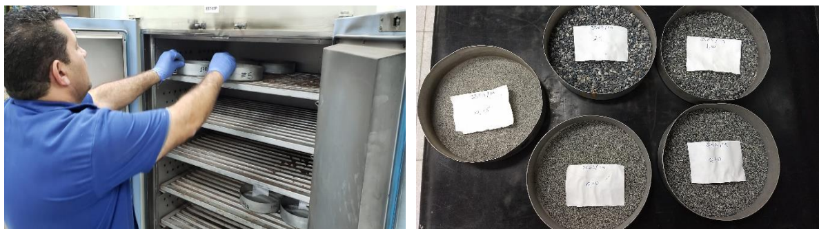
Figura 20 - Secagem das frações das amostras em estufa a 100 °C por mais de 24h até obter uma constância de massa referente a 0,5% (acervo próprio, 2019).
