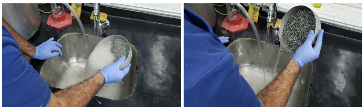
Figura 18 - Lavagem em água corrente e cristalina até remoção de todas as partículas pulverulentas (acervo próprio, 2019).
