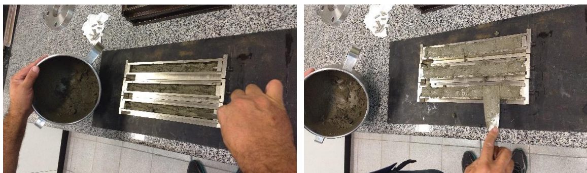
Figura 24 - Moldagem das barras de argamassa sendo realizada em duas camadas (acervo próprio, 2019).
