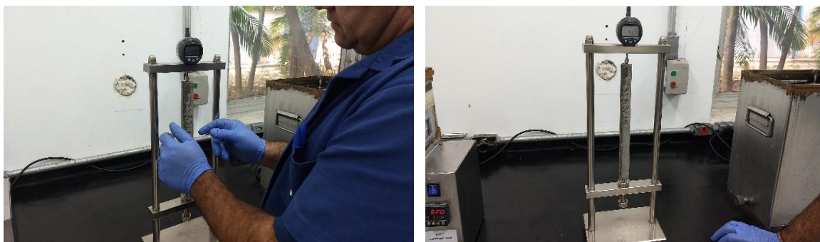
Figura 27 - Leitura inicial das barras de argamassa após 24h da moldagem (acervo próprio, 2019).
