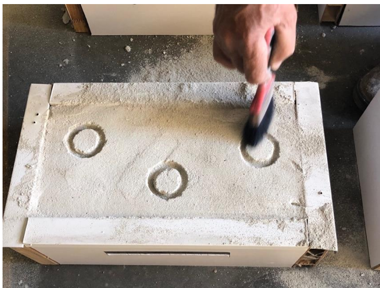
Figura 30 Vista superior - limpeza dos resíduos superficiais com trincha
