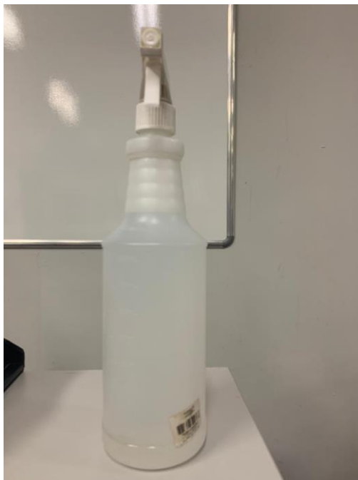
Figura 13 Borrifador utilizado para saturar os blocos
