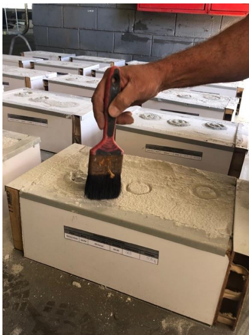
Figura 29 Limpeza dos resíduos superficiais com trincha
