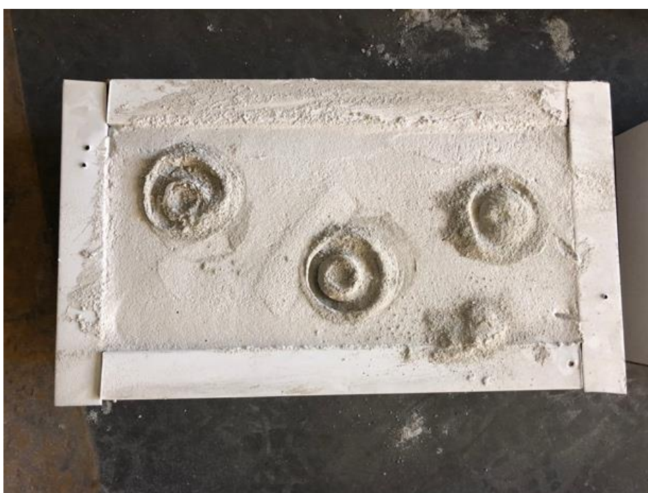
Figura 27 Corte no corpo de prova com a argamassa estabilizada aplicada
