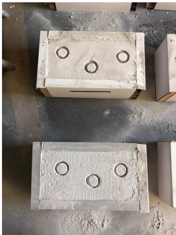
Figura 33 Vista superior – Diferença do corte na argamassa estabilizada e convencional
