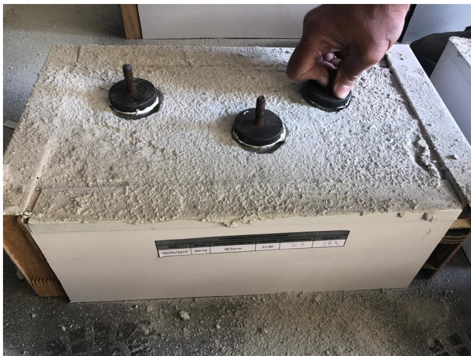
Figura 40 Colagem das placas nos corpos de prova
