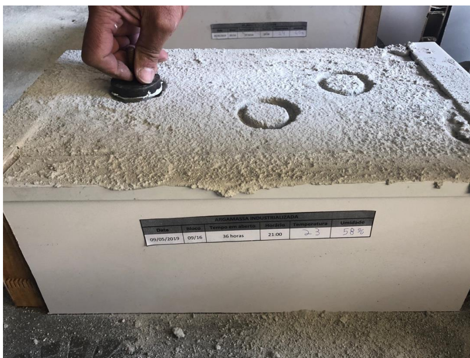
Figura 38 Colagem das placas nos corpos de prova
