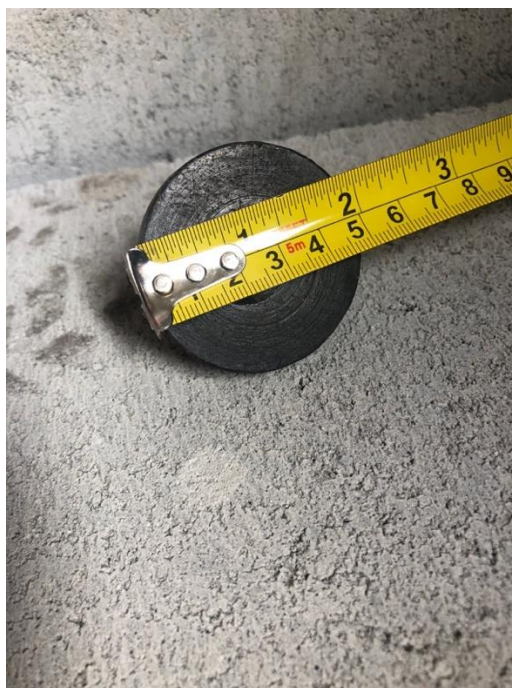
Figura 34 Medida da placa para colagem no substrato
