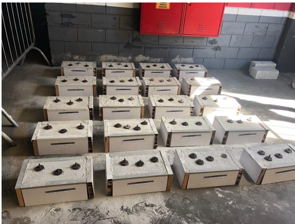
Figura 42 Colagem de todas as placas nos corpos de prova
