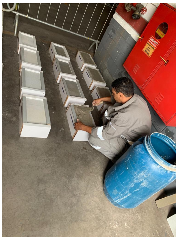
Figura 19 Aplicação da argamassa no corpo de prova saturado
