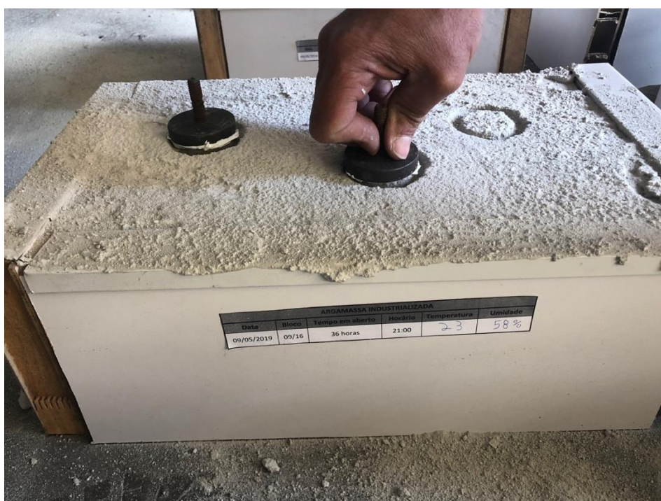
Figura 39 Colagem das placas nos corpos de prova
