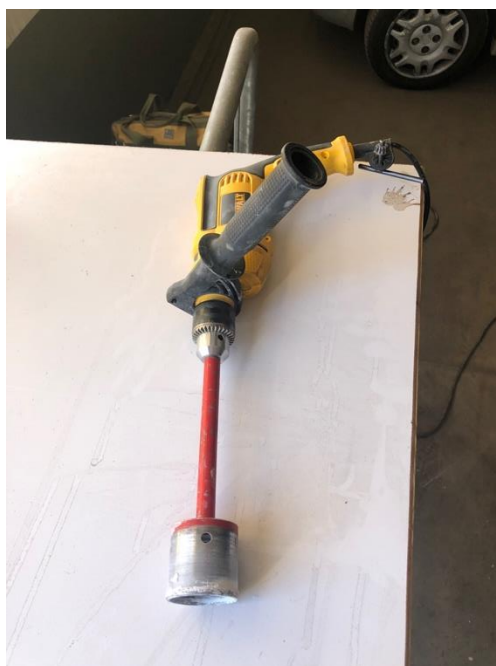
Figura 23 Equipamento utilizado para furação nos corpos de prova
