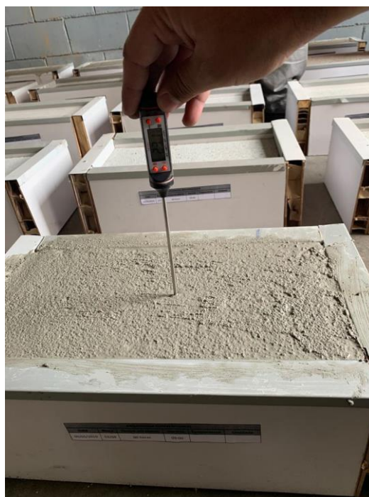
Figura 12 Verificação da temperatura da argamassa
