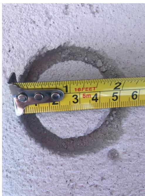
Figura 25 Medida do corte circular padrão
