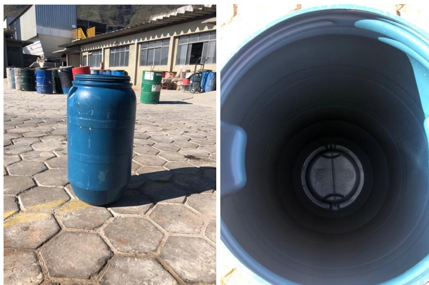
Figura 7 Recipiente para transporte da argamassa estabilizada
