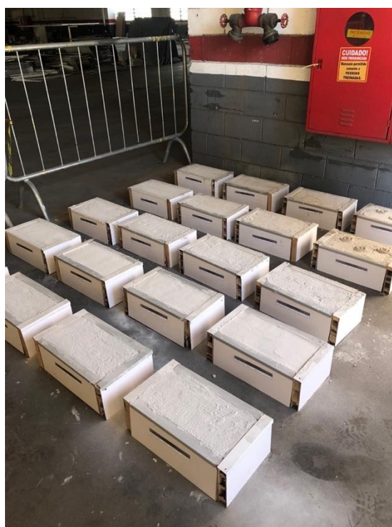
Figura 22 Corpos de Prova com a argamassa aplicada
