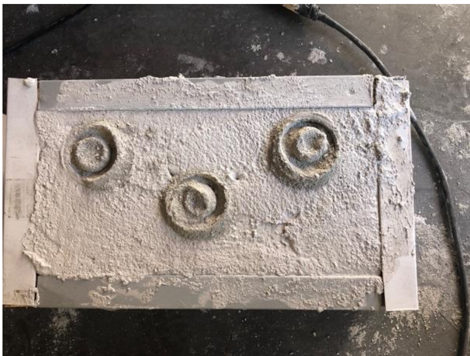
Figura 26 Corte no corpo de prova com a argamassa convencional aplicada
