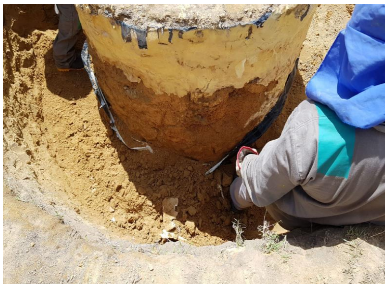
Figura 28 – Escavação do solo e amostra do material aglomerante, no Experimento 1.
