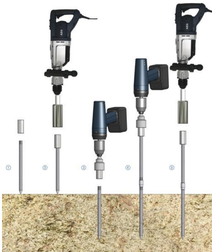
Figura 18 – Ponteiros dos tubos injetores, com esquematização do sistema de encaixe.
