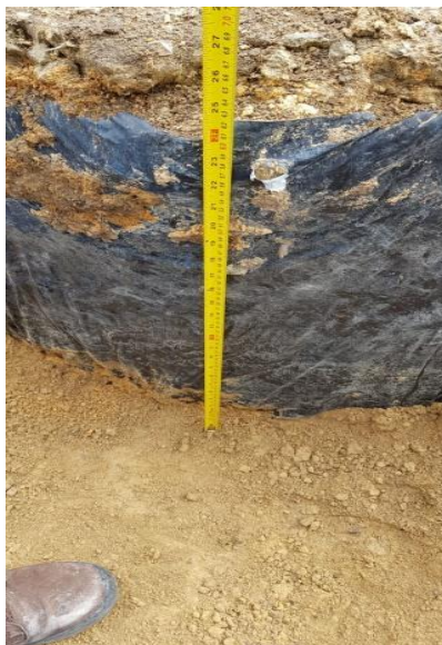
Figura 31 – Detalhe do material arenoso consolidado pelo Poliuretano no Experimento Nº 2
