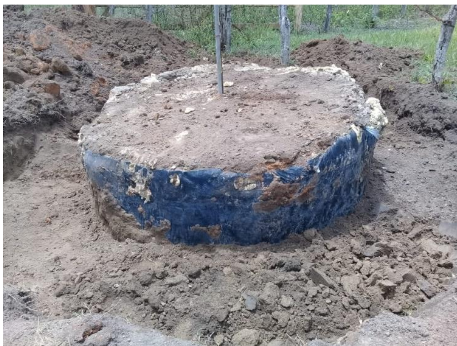
Figura 30 – Escavação do solo e amostra do material aglomerante, no Experimento N° 2.
