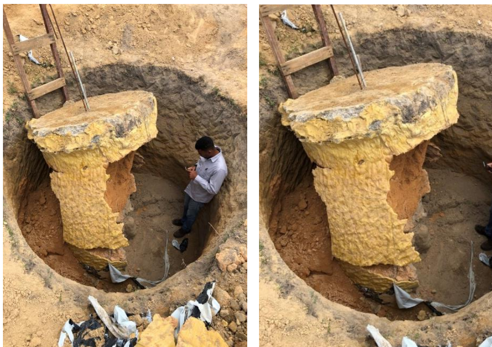
Figura 32 – Solo arenoso consolidado pelo Poliuretano no Experimento Nº 2
