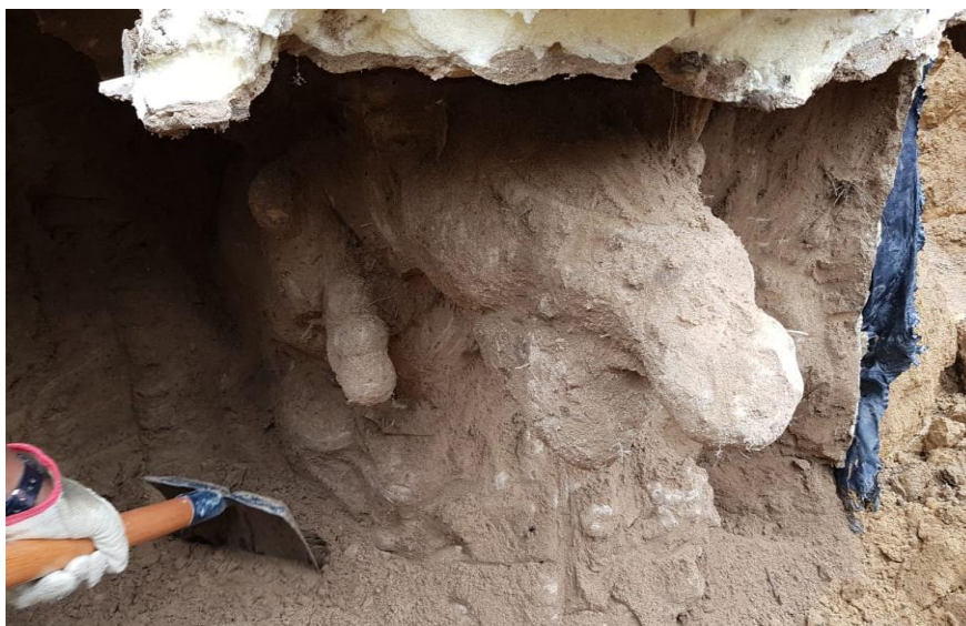
Figura 29 – Escavação do solo e amostra do material aglomerante, no Experimento N° 1, onde constatou-se um comportamento expansivo do Poliuretano melhor que no Experimento N° 2.
