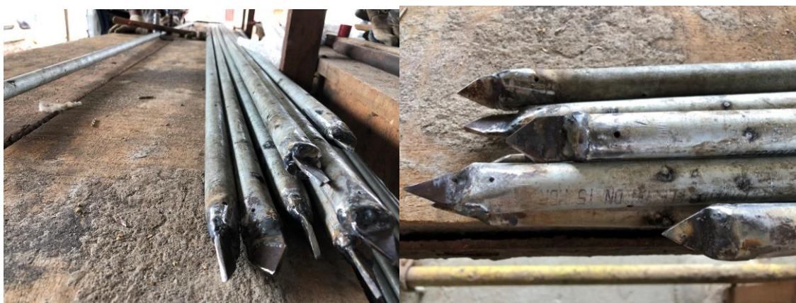
Figura 22 – Ponteiros dos tubos injetores, com furos para passagem da resina de poliuretano.
