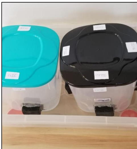
Figura 14. Ensaio acelerado de eflorescência – tentativa do ensaio do “POTE”. Os autores (2018)
