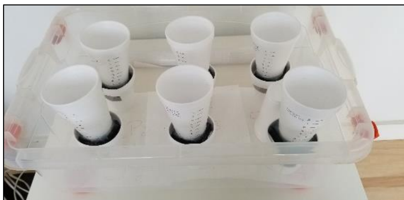
Figura 15. Ensaio acelerado de eflorescência - ensaio do "COPO". Os autores (2018)
