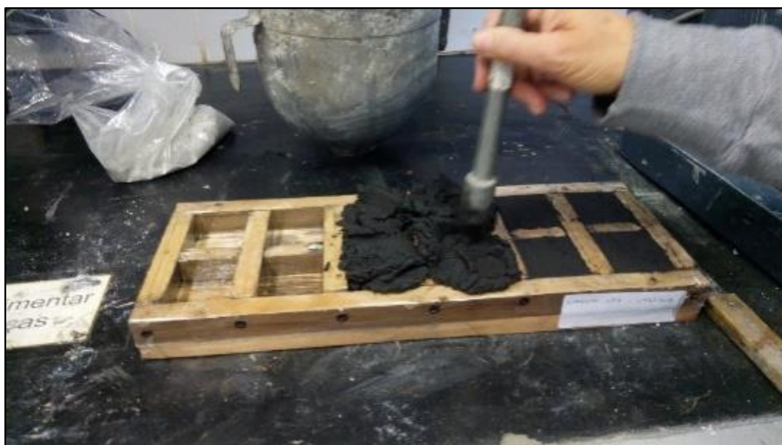
Figura 11. Moldagem dos corpos de prova. Os autores (2018)
