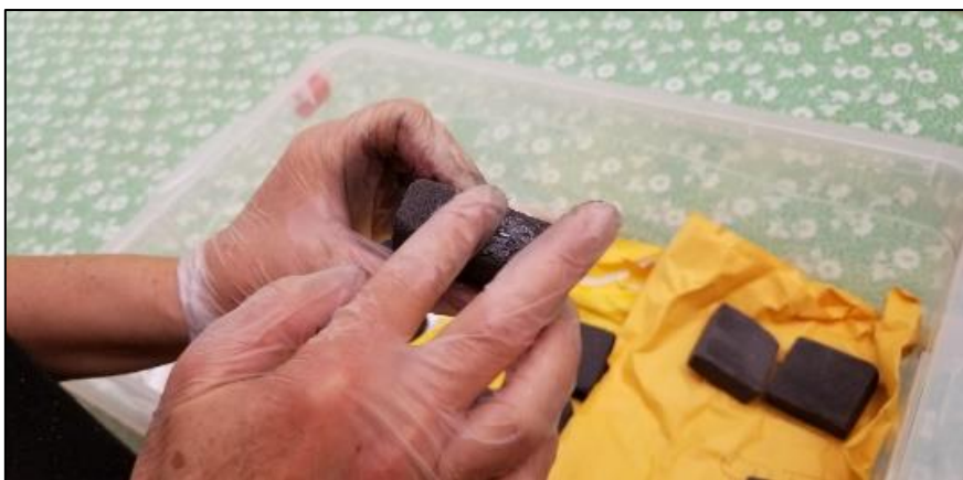
Figura 13. Lixamento e aplicação de selante. Os autores (2018)
