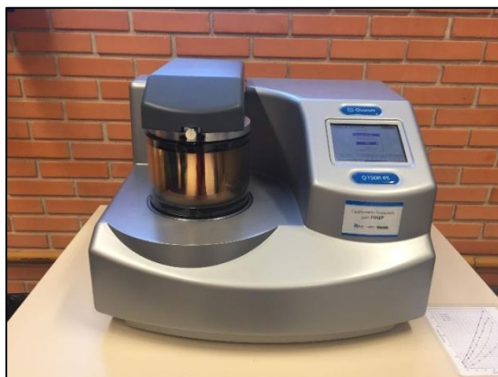
Figura 22. Equipamento utilizado para recobrimento com deposição metálica sobre as amostras não condutoras. Fonte: Os autores (2019)
