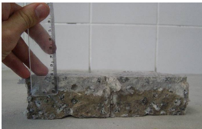
Figura 11 – Medida da profundidade de penetração de cloretos pelo método colorimétrico visual por aspersão de solução de \text{AgNO}_3 0,1 M (MEDEIROS, 2008)
