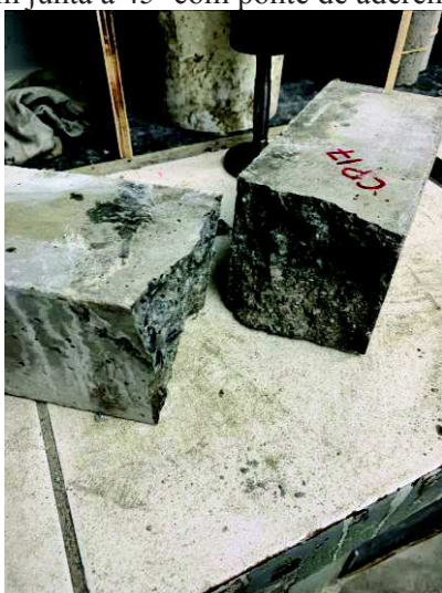
Foto 52 – CP-17 – série de corpos de prova com junta a 45° com ponte de aderência.
