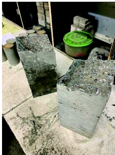
Foto 65 – CP-30 – série de corpos de prova com junta a 45° sem ponte de aderência.
