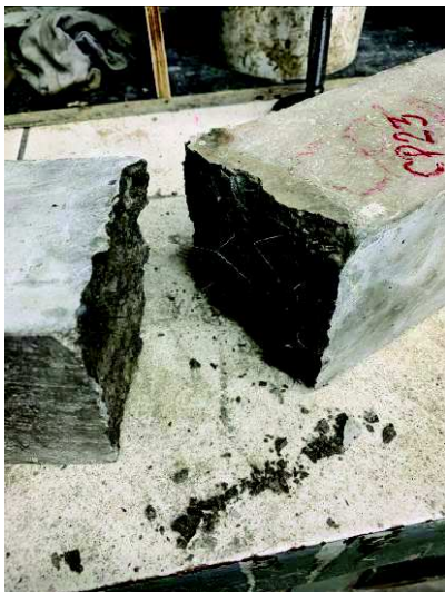
Foto 58 – CP-23 – série de corpos de prova com junta a 90° sem ponte de aderência.
