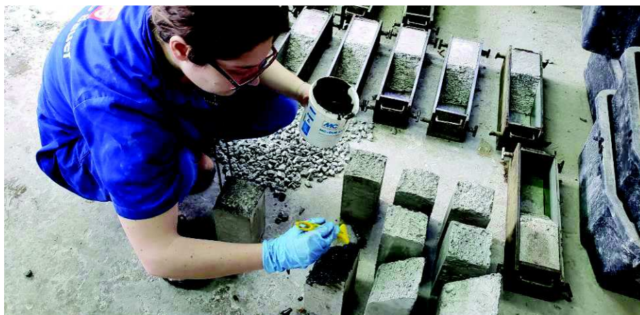
Foto 24 – Aplicação de ponte de aderência na região de junta de concretagem.
