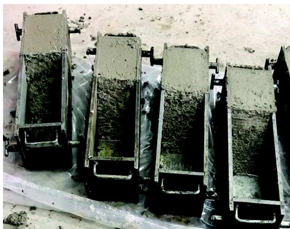
Foto 19 – Corpos de prova de concreto com junta posicionada de forma inclinada, a 45°.
