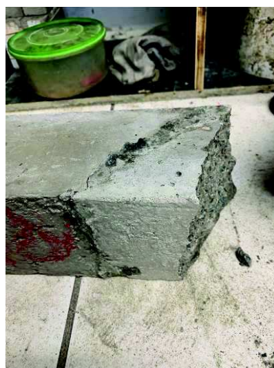
Foto 49 – CP-14 – série de corpos de prova com junta a 45° com ponte de aderência.
