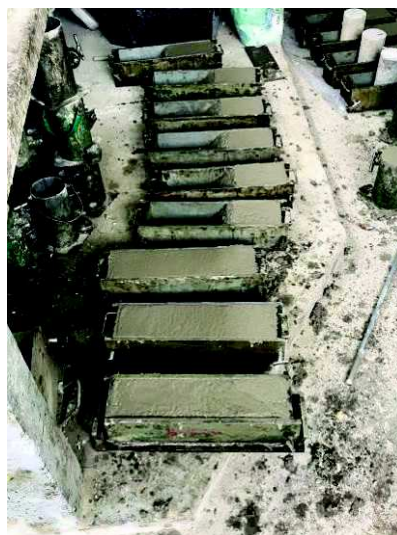
Foto 18 – Vista de corpos de prova de concreto moldados na 1ª etapa de concretagem.
