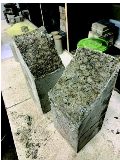
Foto 60 – CP-25 – série de corpos de prova com junta a 45° sem ponte de aderência.
