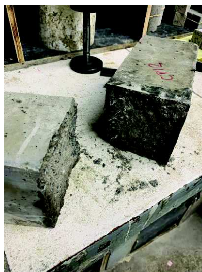
Foto 47 – CP-12 – série de corpos de prova com junta a 90° com ponte de aderência.
