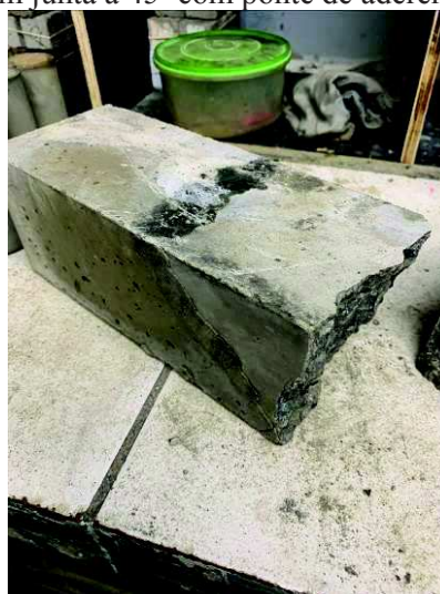
Foto 53 – CP-18 – série de corpos de prova com junta a 45° com ponte de aderência.
