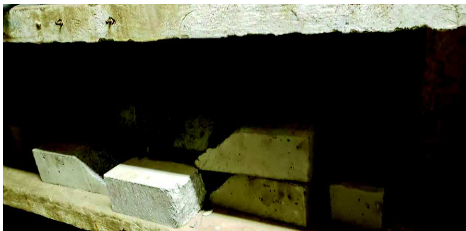
Foto 21 – Corpos de prova de concreto armazenados na câmara úmida para cura.
