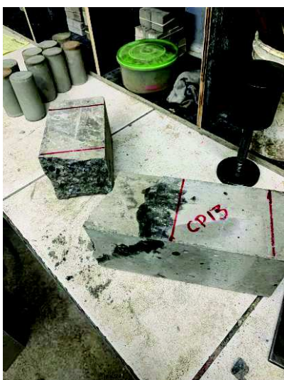
Foto 48 – CP-13 – série de corpos de prova com junta a 45° com ponte de aderência.
