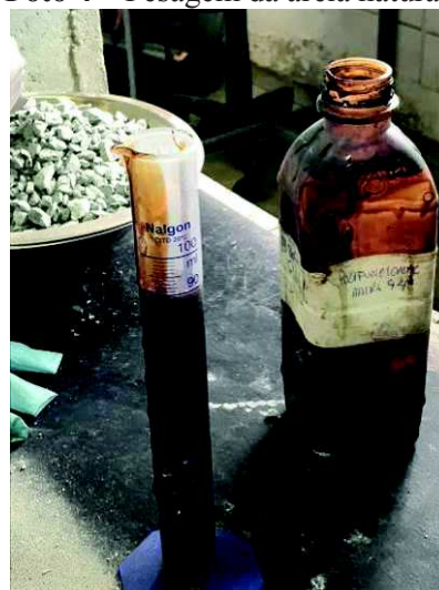
Foto 6 – Dosagem do aditivo polifuncional.
