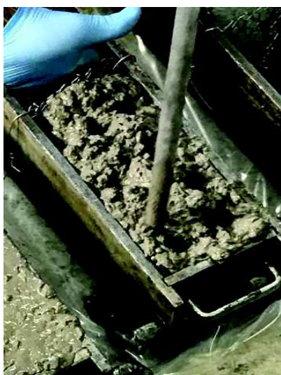
Foto 17 – Moldagem de corpo de prova de concreto.
