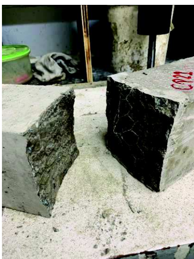
Foto 56 – CP-21 – série de corpos de prova com junta a 90° sem ponte de aderência.
