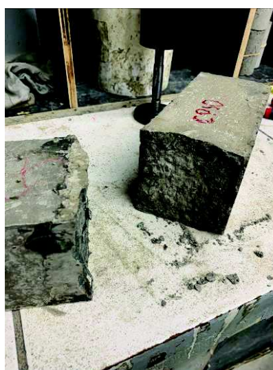
Foto 45 – CP-10 – série de corpos de prova com junta a 90° com ponte de aderência.
