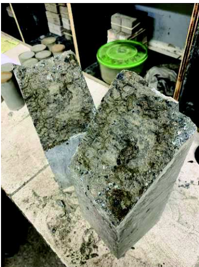
Foto 64 – CP-29 – série de corpos de prova com junta a 45° sem ponte de aderência.
