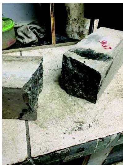
Foto 51 – CP-16 – série de corpos de prova com junta a 45° com ponte de aderência.
