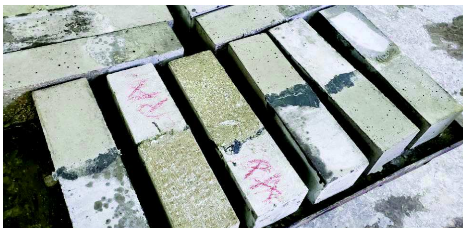
Foto 30 – Vista dos corpos de prova após desmoldagem.
