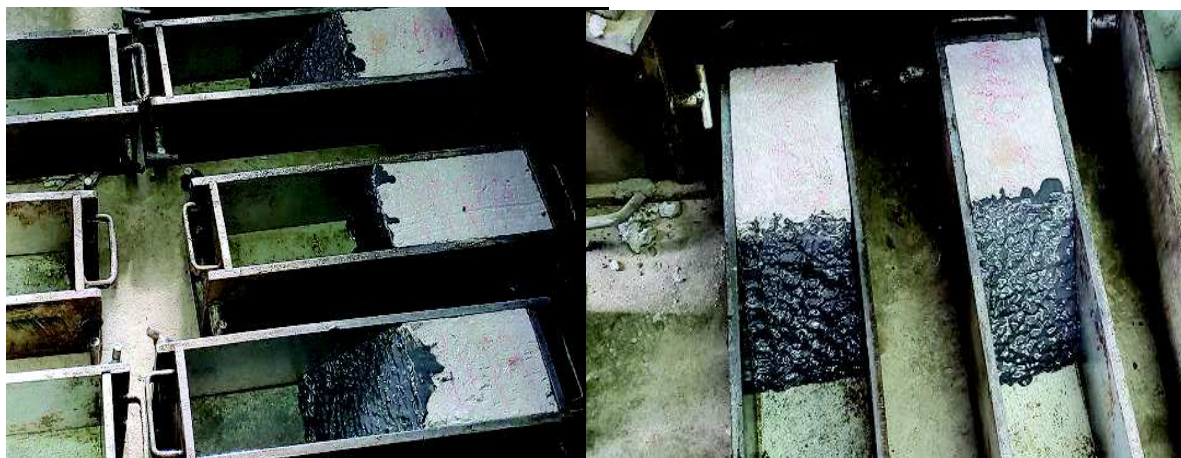
Foto 25 – Corpos de prova de concreto com o emprego de ponte de aderência na região de junta de concretagem.
