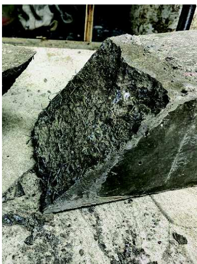
Foto 62 – CP-27 – série de corpos de prova com junta a 45° sem ponte de aderência.
