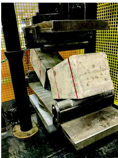
Foto 35 – CP-1 – detalhe para a ruptura do corpo de prova de forma centralizada.
