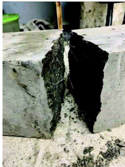
Foto 59 – CP-24 – série de corpos de prova com junta a 90° sem ponte de aderência.
