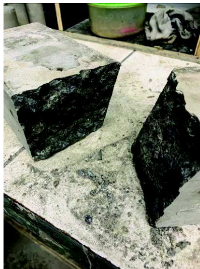
Foto 63 – CP-28 – série de corpos de prova com junta a 45° sem ponte de aderência.
