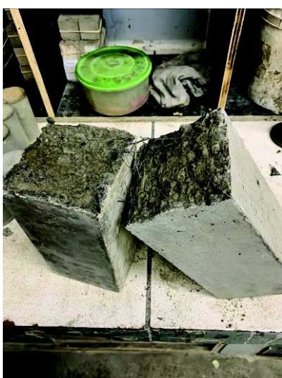
Foto 54 – CP-19 – série de corpos de prova com junta a 90° sem ponte de aderência.
