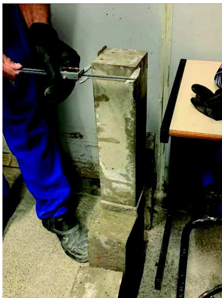
Foto 32 – Medição da dimensão do corpo de prova.
