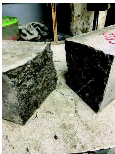
Foto 57 – CP-22 – série de corpos de prova com junta a 90° sem ponte de aderência.
