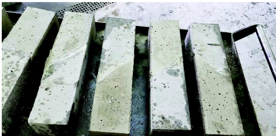
Foto 29 – Vista dos corpos de prova após desmoldagem.
