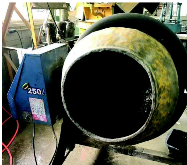
Foto 8 – Homogeneização do concreto na betoneira estacionária.
