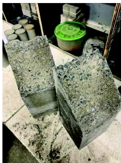
Foto 61 – CP-26 – série de corpos de prova com junta a 45° sem ponte de aderência.
