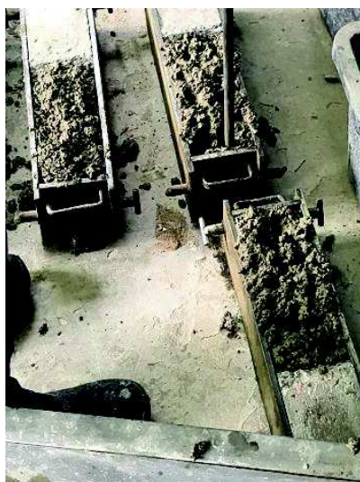
Foto 27 – Moldagem dos corpos de prova prismáticos.
