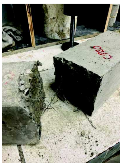
Foto 55 – CP-20 – série de corpos de prova com junta a 90° sem ponte de aderência.
