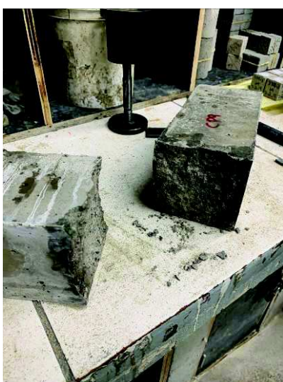
Foto 44 – CP-9 – série de corpos de prova com junta a 90° com ponte de aderência.
