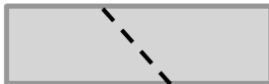
Figura 4 – Junta de concretagem com posicionamento inclinado a 45^\circ .
