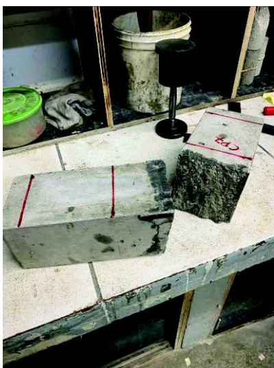
Foto 42 – CP-7 – série de corpos de prova com junta a 90° com ponte de aderência.
