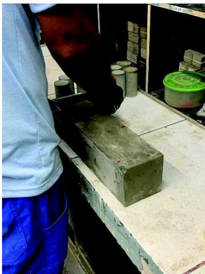
Foto 33 – Marcação de corpo de prova para facilitar o posicionamento na prensa.
