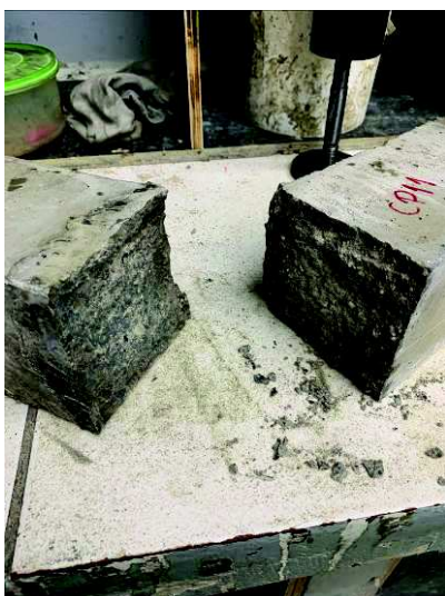
Foto 46 – CP-11 – série de corpos de prova com junta a 90° com ponte de aderência.
