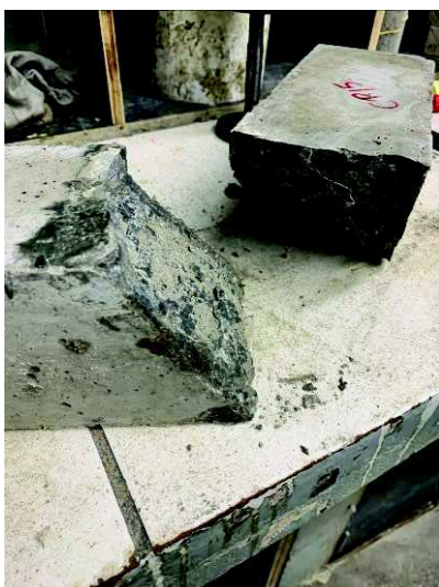
Foto 50 – CP-15 – série de corpos de prova com junta a 45° com ponte de aderência.
