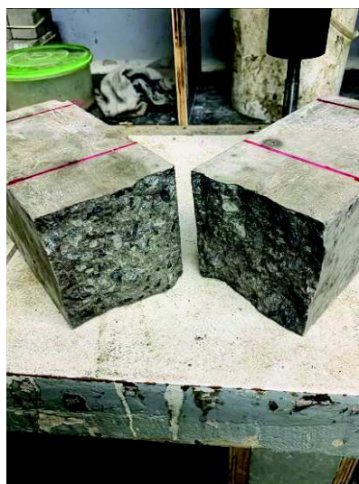
Foto 36 – CP-1 – vista do corpo de prova rompido.
