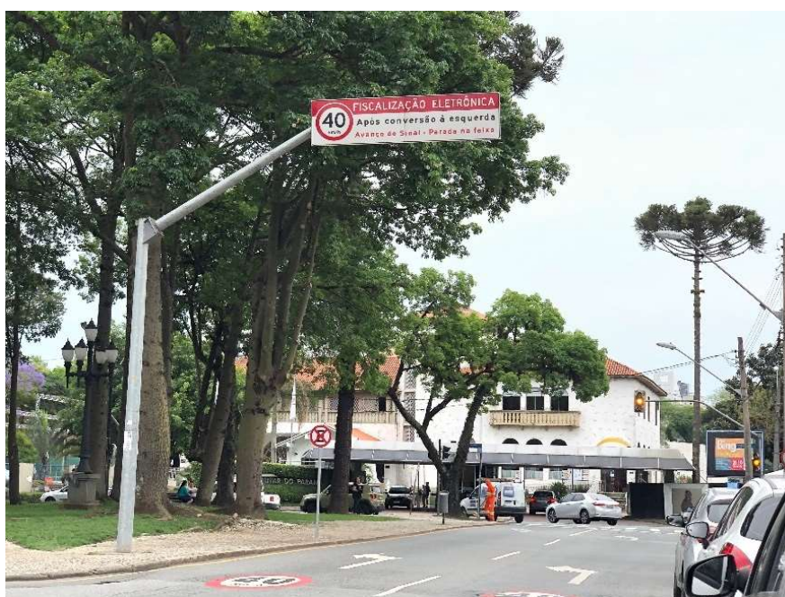
FIGURA 7 – SINALIZAÇÃO VERTICAL E HORIZONTAL NA ‘ÁREA CALMA’
