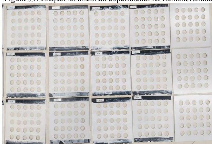
Figura 39: Chapas no início do experimento na Câmara Salina.
