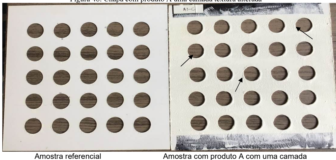
Figura 46: Chapa com produto A uma camada textura alterada
