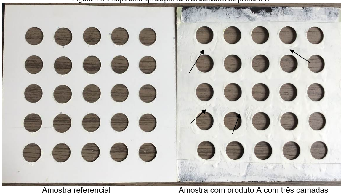
Figura 54: Chapa com aplicação de três camadas de produto C
