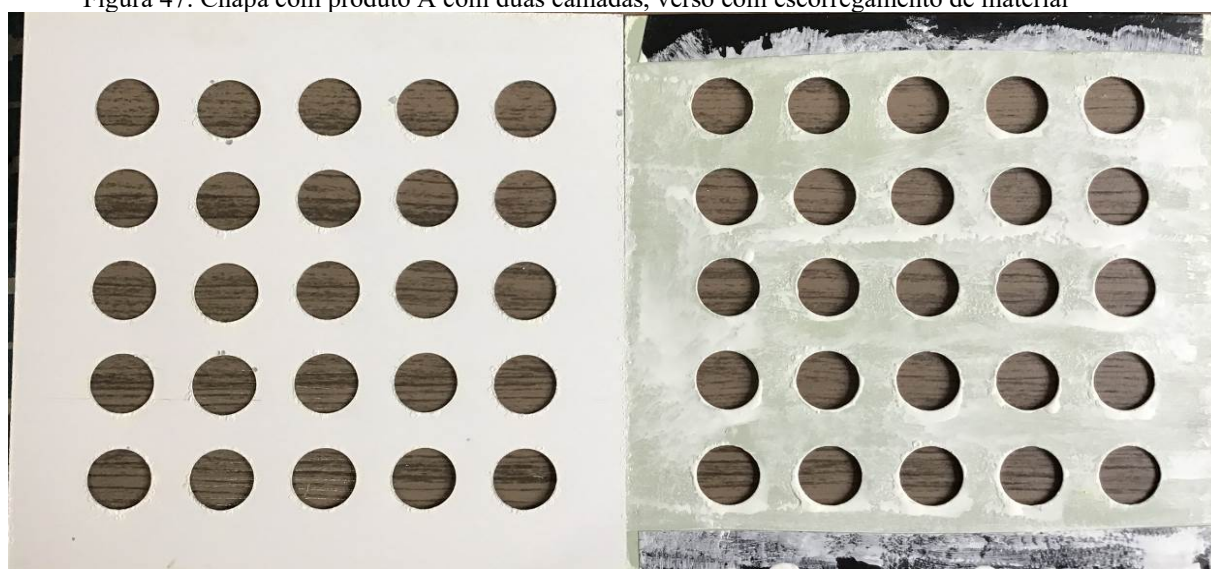
Figura 47: Chapa com produto A com duas camadas, verso com escorregamento de material
