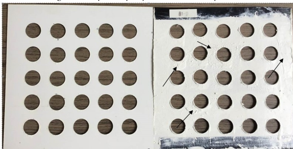
Figura 49: Chapa com aplicação de uma camada de produto B
