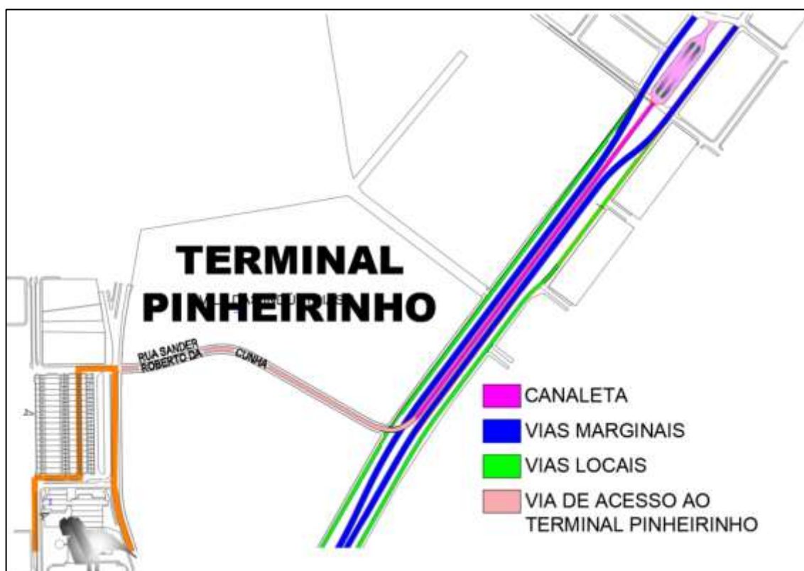
Figura 23 - Nova estrutura viária da Linha Verde
