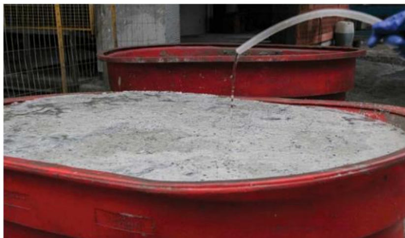
Figura 23 – Argamassa estabilizada com película de água de 2cm
