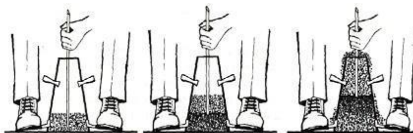
Figura 11 – Adensamento do Slump Test
