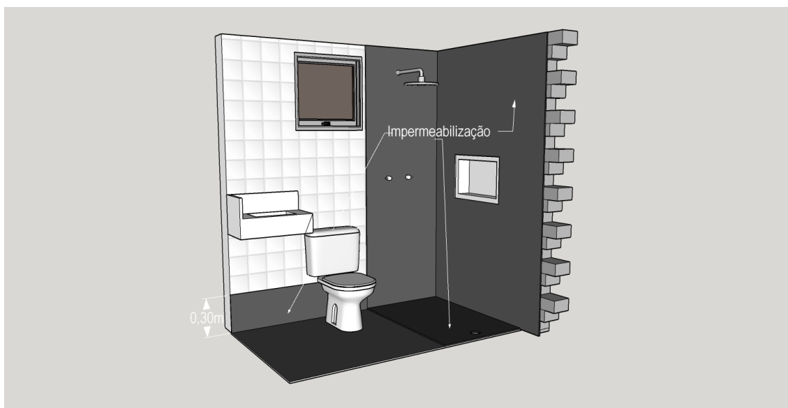
Figura 4 - Impermeabilização Box e Banheiro. Fonte: Autor, 2019.
