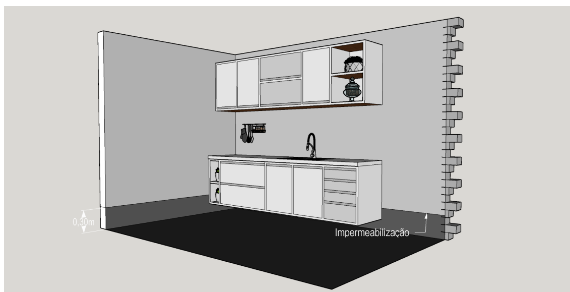
Figura 3 - Impermeabilização Área Molhada. Fonte: Autor, 2019.
