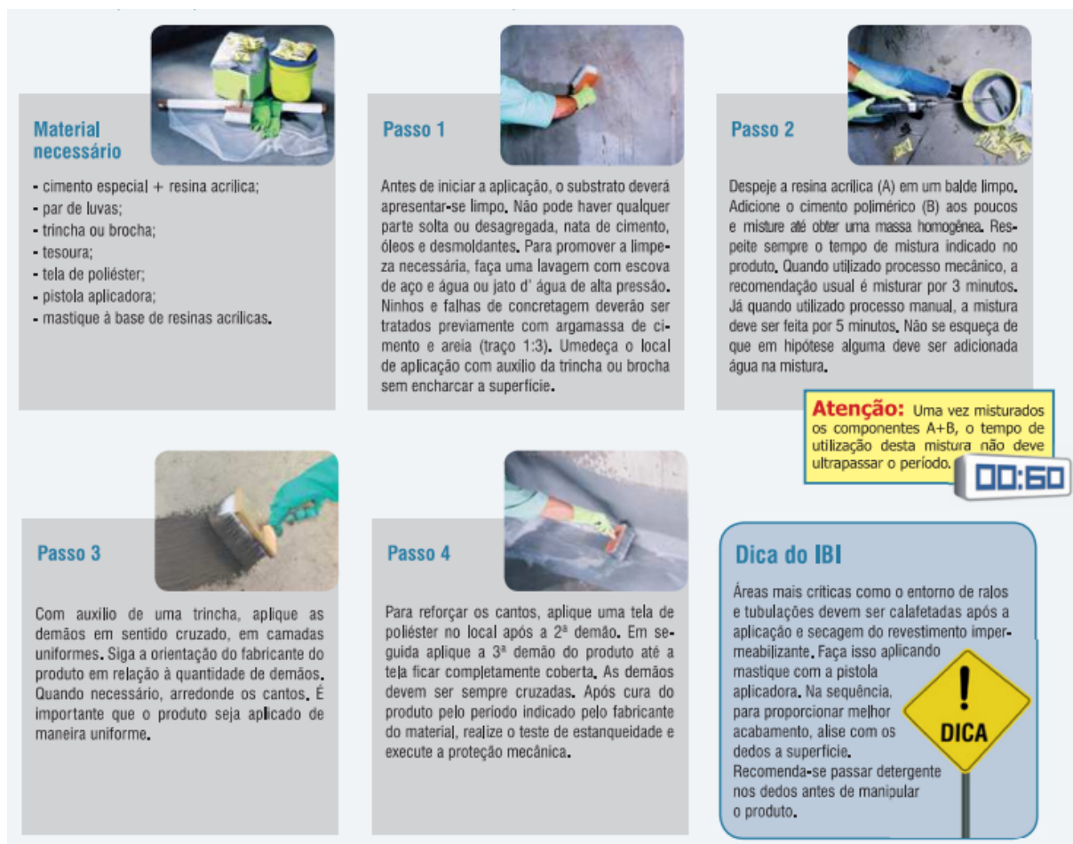
Figura 1 – Impermeabilização com argamassa polimérica.
