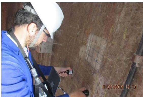
Foto 18 - Realização do ensaio de ultrassonografia.
