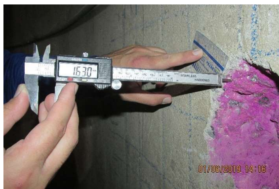
Foto 17 – Ensaio de alcalinidade do concreto.
