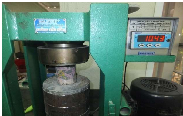
Foto 21 – Ensaio de Resistência a compressão.
