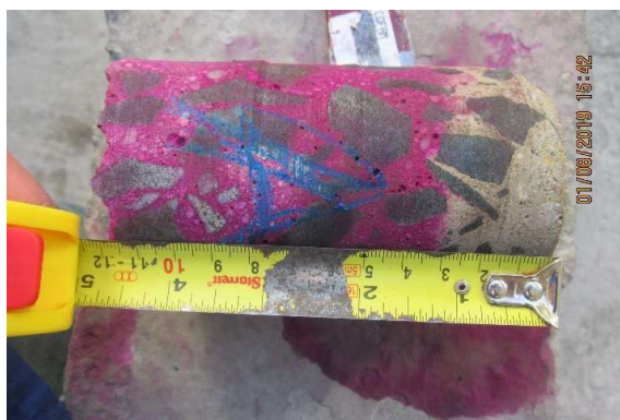
Foto 3 - Ensaio para identificar a frente de carbonatação.
