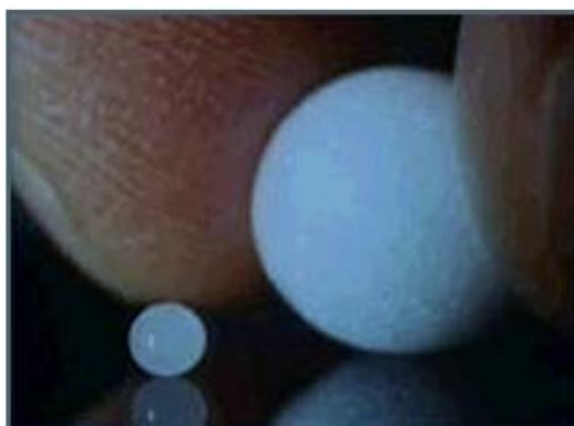
Figura 1 – Pérola de poliestireno antes e após sua expansão (ACEPE, 2006)
