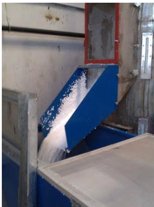
Figura 3 – Pré expansor de EPS (NKL CHINA)
