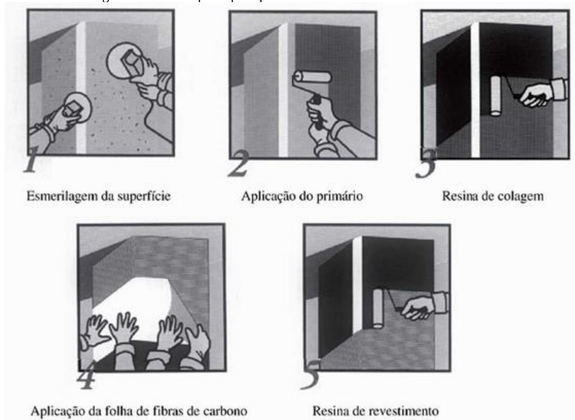
Figura 25 – Passos para aplicação de folhas flexíveis de fibras de carbono
