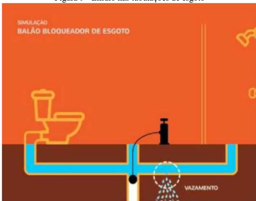
Figura 9 - Ensaio nas tubulações de esgoto
