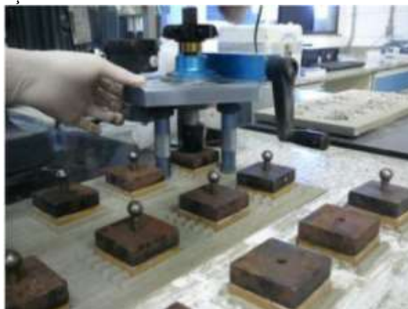
Figura 8 - Execução do ensaio de arrancamento de revestimento cerâmico
