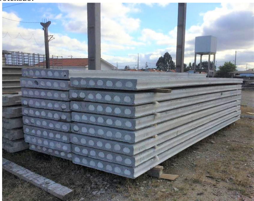
Figura 1 – Lajes alveolares protendidas - O Autor (2019).
