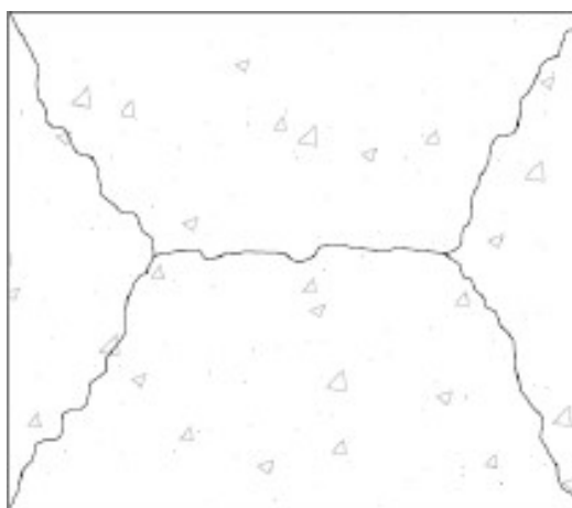
Figura 55. Fissuras em laje por excesso de carga (TOMAZELI, 2019).
