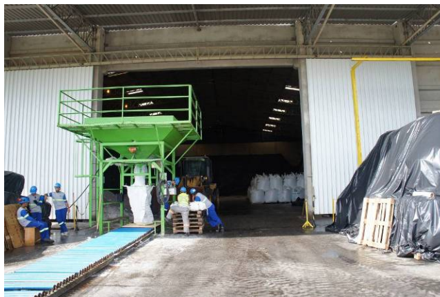
Figura 40. Detalhe de máquina ensacadeira (AUTOR, 2019).
