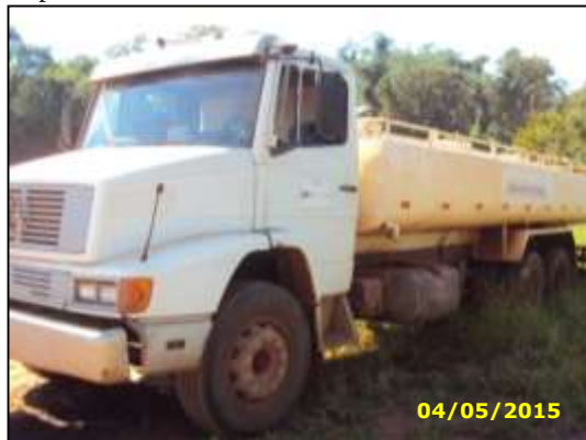
Figura 40 – Caminhão pipa utilizado no combate da poeira, km 131+960.
