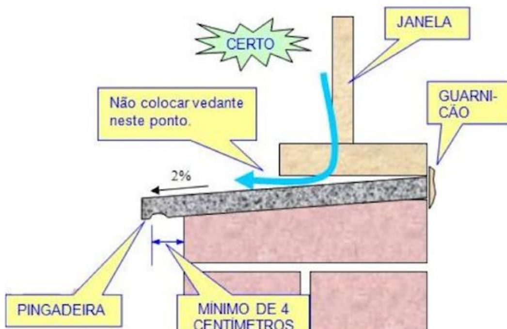
Figura 48 - Detalhe Esquadria – Peitoril Fonte: http://construindodecor.com.br/pingadeira/
