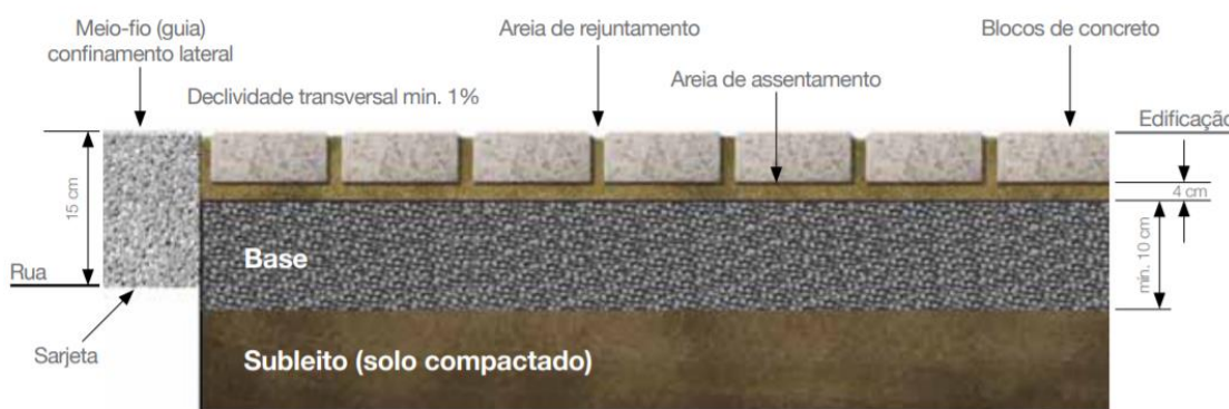
Figura 77. Procedimento construtivo paver (ABCP, 2010)
