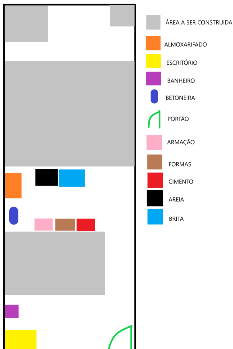
Figura 47. Layout canteiro de obra (OS AUTORES, 2019)
