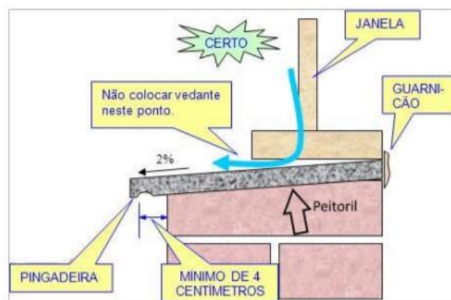
Figura 68. Impermeabilização de janelas (VACCHIANO, 2016).
