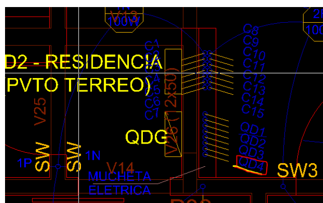
Figura 31. Indicação dos quadros de distribuição (OS AUTORES, 2019).
