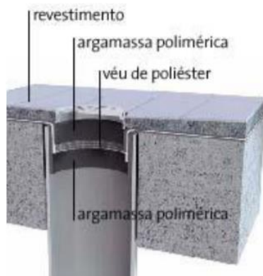
Figura 66. Impermeabilização de ralo com argamassa polimérica (VACCHIANO, 2016)
