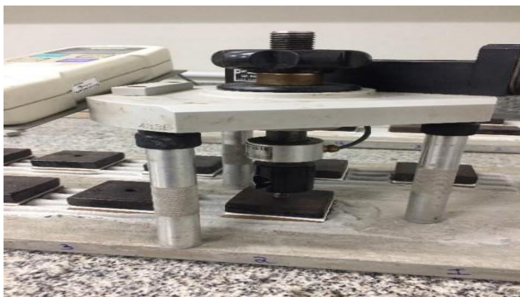
Figura 26: Equipamento de arrancamento.
