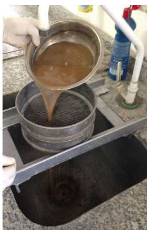
Figura 8. Lavagem de amostra para eliminação de material Fino (75 \mu m) (Autor,apoio laboratório terceiro, 2019, s.p)
