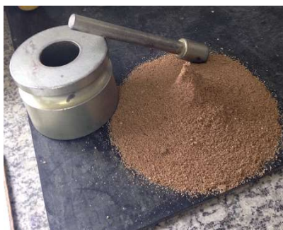
Figura 14. Ensaio de Agregado Miúdo com o Tronco-cônico (Autor, apoio laboratório terceiro, 2019, s.p)
