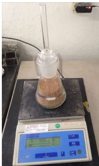
Figura 9. Pesagem do Conjunto Frasco e Agregado Miúdo (Autor,apoio laboratório terceiro, 2019, s.p)
