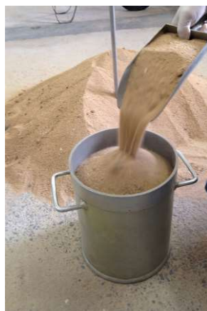
Figura 15. Ensaio de Massa Unitária para Agregado Miúdo (Autor,apoio laboratório terceiro, 2019, s.p)
