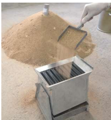
Figura 6. Quarteamento do Agregado Miúdo Fonte: (Autor,apoio laboratório terceiro, 2019, s.p)
