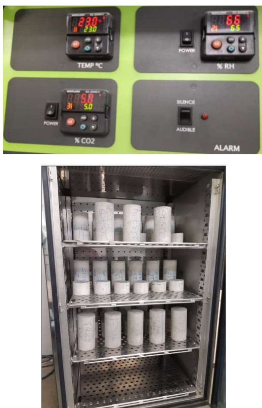
Figura 20. Câmara de Carbonatação de concretos (Autor,apoio laboratório terceiro, 2019, s.p)
