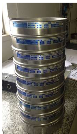
Figura 7. Conjunto de Peneiras para Ensaio Granulométrico de Agregado Miúdo (Autor,apoio laboratório terceiro, 2019, s.p)
