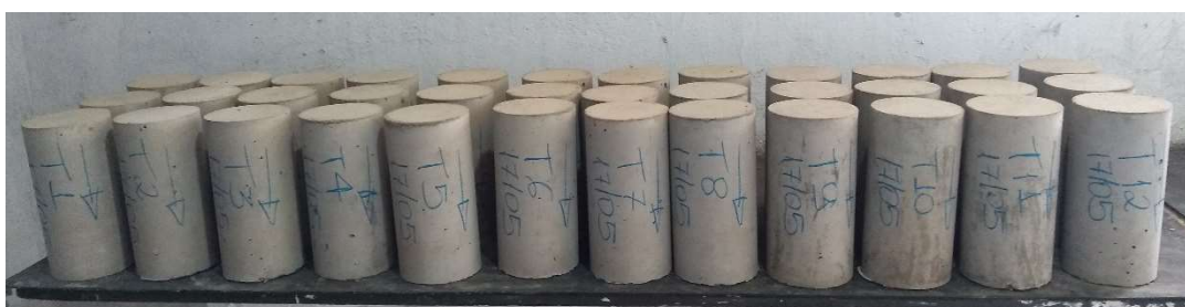
Figura 17. Corpos de Provas 10x20 cm (Autor,apoio laboratório terceiro, 2019, s.p)
