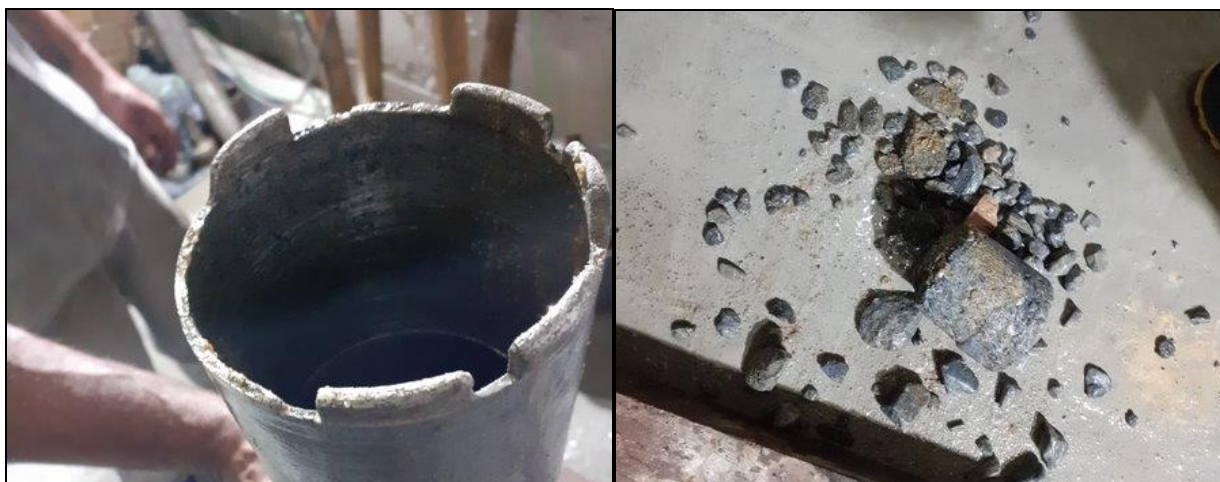
Figura 13 - Coroa danificada devido aos vazios do concreto.
