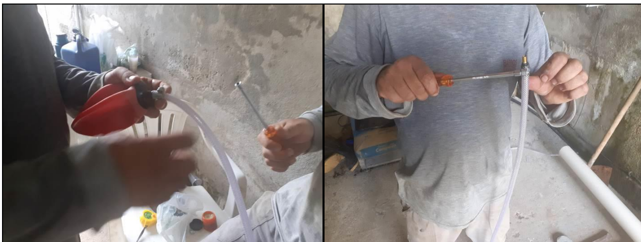
Figura 16 - Instalação da mangueira extensora no obturador
