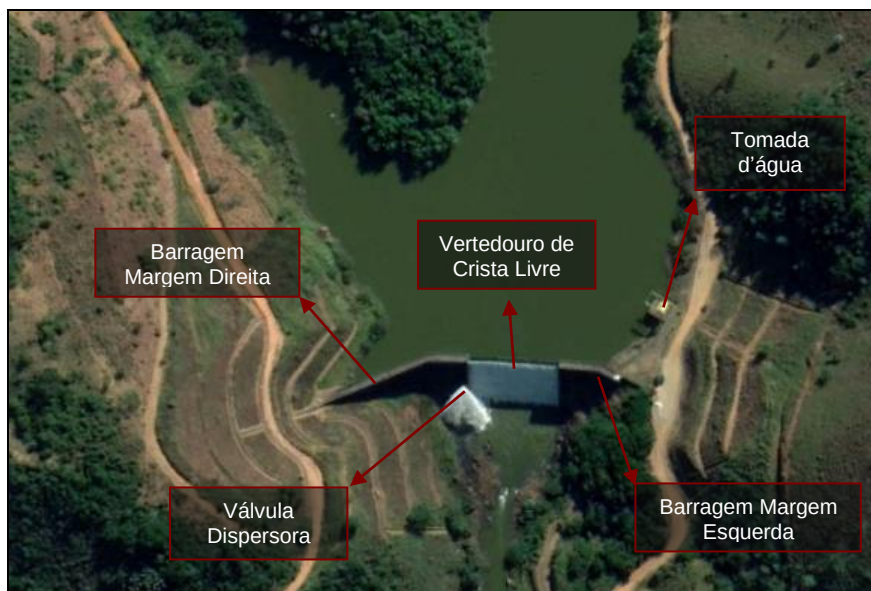
Figura 1 - Arranjo Geral do barramento da UHE Rosal
