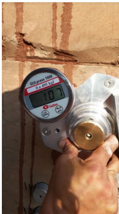
Figura 38 - Resultado do ensaio de arrancamento do CP 1 do pano teste 1. Fonte: autores, 2020
