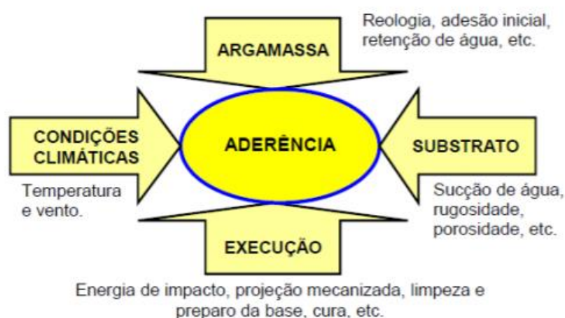
Figura 5 - Fatores que exercem influência na aderência de argamassa sobre base porosa
