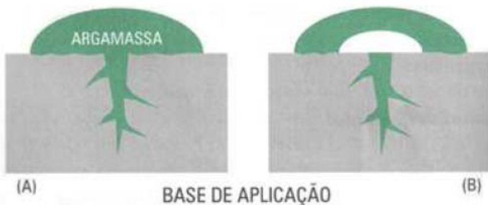
Figura 4 - a) Argamassa com boa aderência inicial; (b) Perda de aderência inicial por descontinuidade da argamassa.
