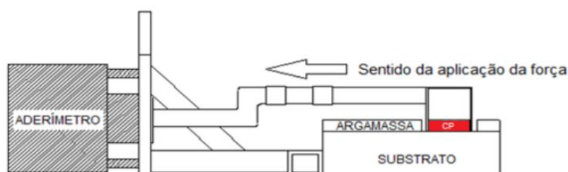
Figura 11 - Corte apresentando a aplicação do dispositivo para execução do ensaio de resistência ao cisalhamento.
