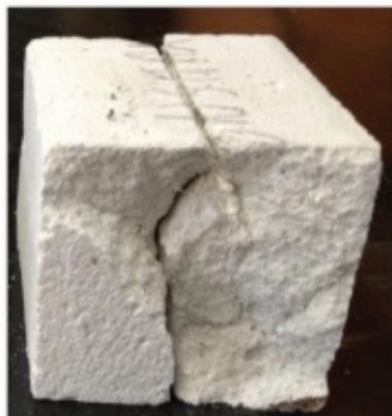
Figura 12 - Formato típico das fissuras
