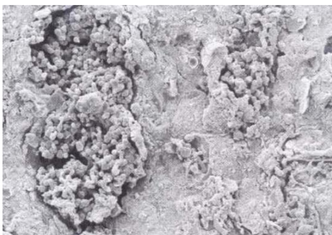
Figura 28 - Foto ampliada mostrando o aspecto da textura de colônia de fungos.
