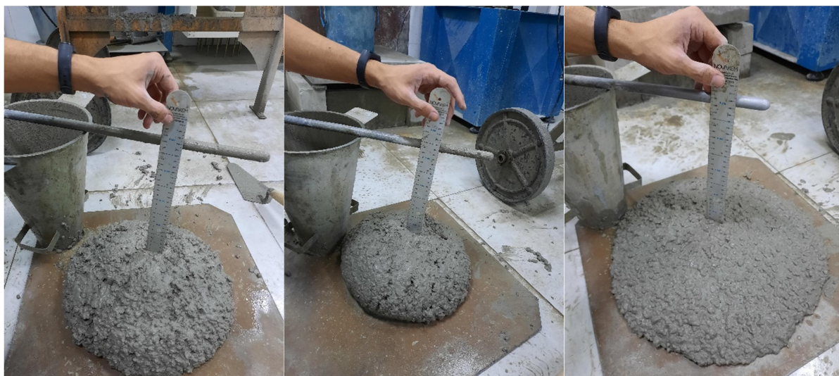
Figura 16 – Resultado de ensaios de abatimento de tronco de cone dos traços referência (esquerda), redução de água (meio), e com aditivo incorporador de ar (direita).
