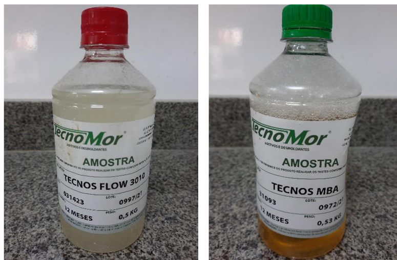
Figura 12 - Aditivo redutor de água tipo 2 (esquerda) e aditivo incorporador de ar (AIA). Fonte: Autores.
