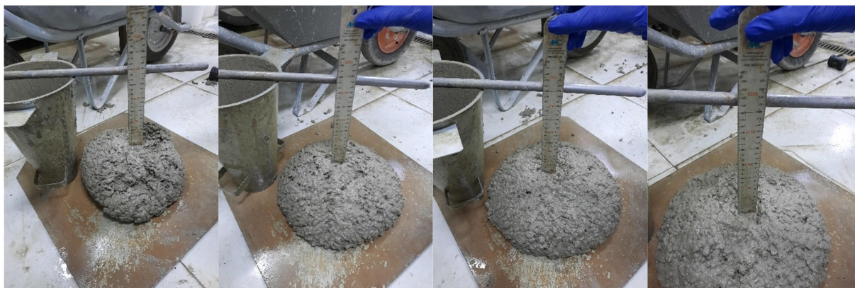
Figura 23 – Ensaios de abatimento de tronco de cone dos traços com a/c redução 7%, na sequência os traços 9,10,11 e 12.
