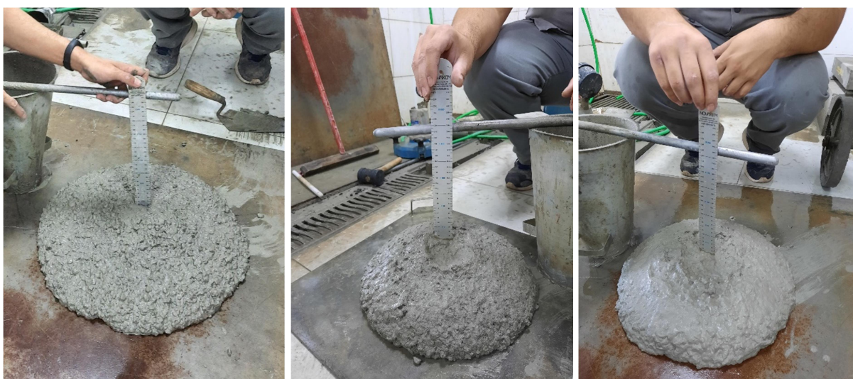
Figura 13 – Resultado de ensaios de abatimento de tronco de cone dos traços referência (esquerda), redução de água (meio), e com aditivo incorporador de ar (direita).
