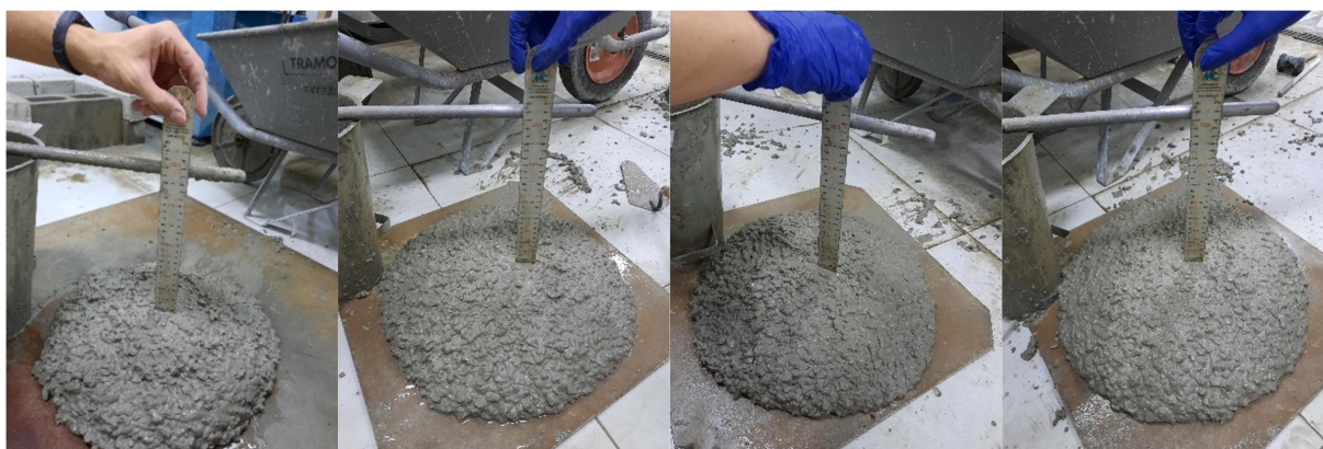
Figura 19 – Ensaios de abatimento de tronco de cone dos traços com a/c Referência, na sequência os traços 1,2,3 e 4.
