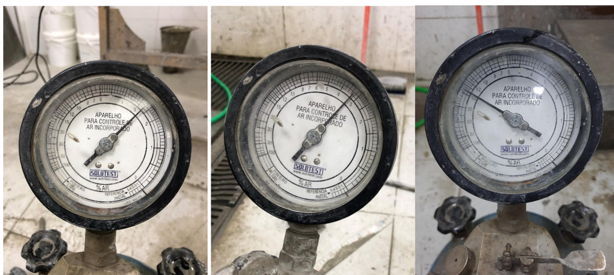
Figura 15 – Aferição de teor de ar incorporado dos traços referência (esquerda), redução de água (meio), e com aditivo incorporador de ar (direita).
