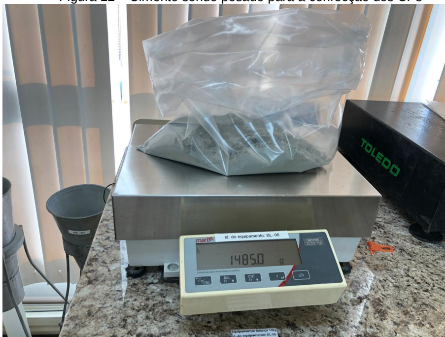
Figura 12 – Cimento sendo pesado para a confecção dos CPs
