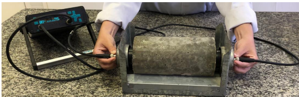
Figura 1 - Esquema do posicionamento dos transdutores para as medidas de velocidade de ultrassom nos corpos de prova cilíndricos 10 cm x 20 cm (GODINHO et al. 2020).
