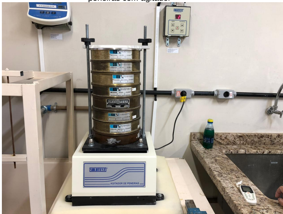
Figura 13 – Teste de granulometria do agregado graúdo, executado em peneiras com agitador
