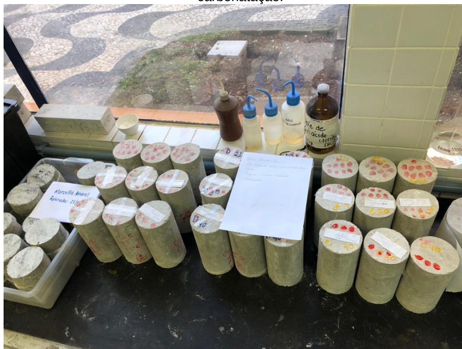
Figura 44– Organização e classificação dos corpos de prova antes da colocação na câmara de carbonatação.
