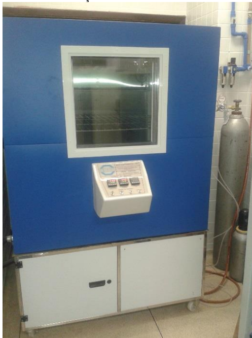
Figura 23 – Câmara de carbonatação do laboratório LAME/DCC/CESEC da UFPR.
