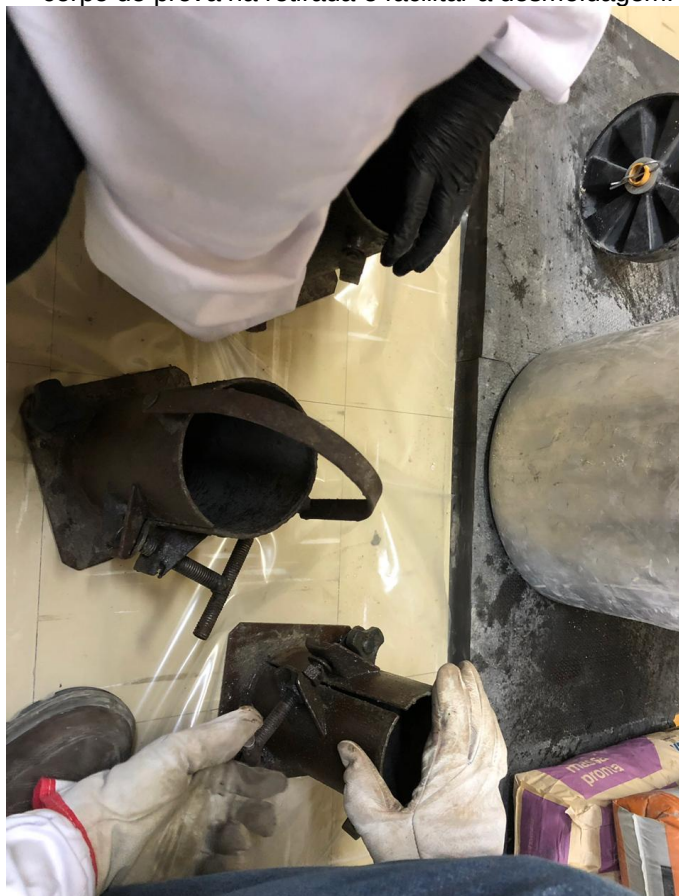
Figura 37 – Aplicação de desmoldante nas peças de moldes metálicos, de modo a não danificar o corpo de prova na retirada e facilitar a desmoldagem.
