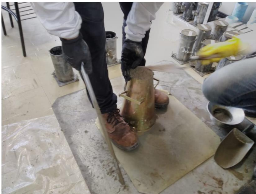
Figura 40 – Etapa de procedimento do Teste de Abatimento.
