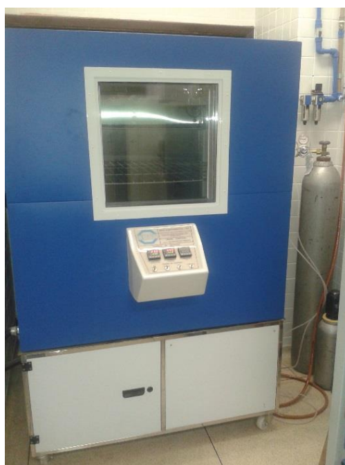
Figura 4 – Câmara de carbonatação do laboratório LAME/DCC/CESEC da UFPR.
