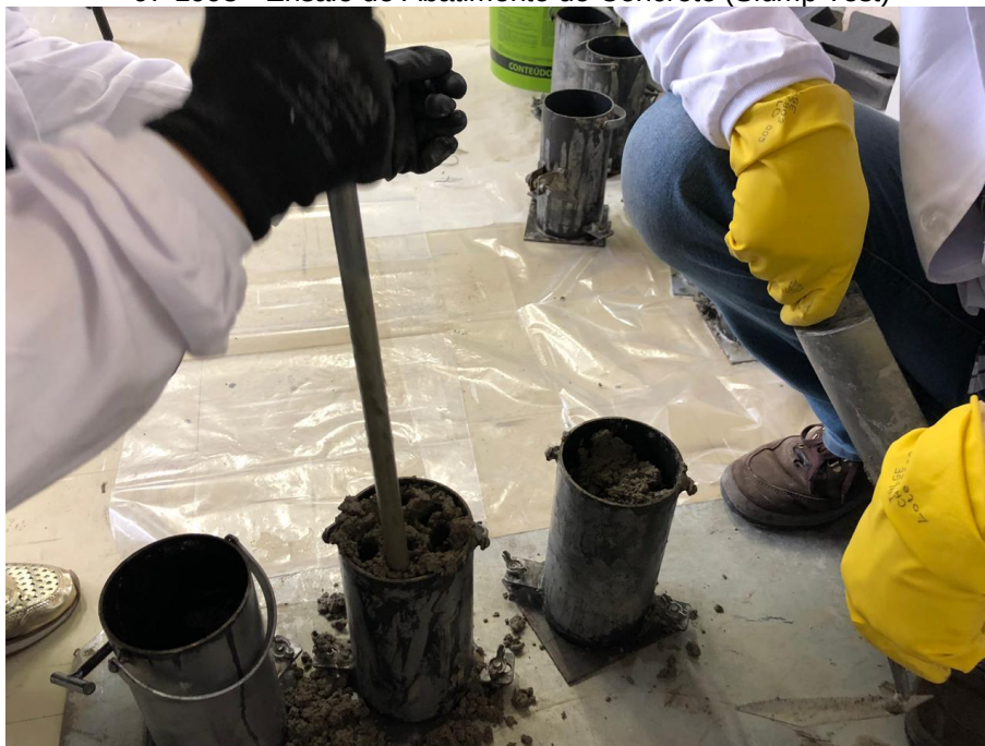
Figura 49 – Apiloamento da pasta de concreto para teste de Abatimento, conforme norma NBR NM 67-1998 - Ensaio de Abatimento do Concreto (Slump Test)
