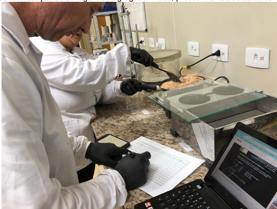
Figura 33 – Execução de secagem do agregado miúdo, procedimentos de cálculos e análises.
