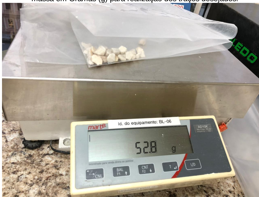
Figura 31 – Pesagem do agregado graúdo, balança de precisão para aferição e conferência de massa em Gramas (g) para realização dos traços desejados.
