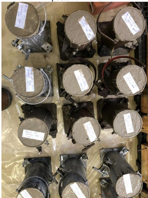
Figura 42 – Desmoldagem dos corpos de prova após um dia da moldagem, para imersão em água posteriormente.
