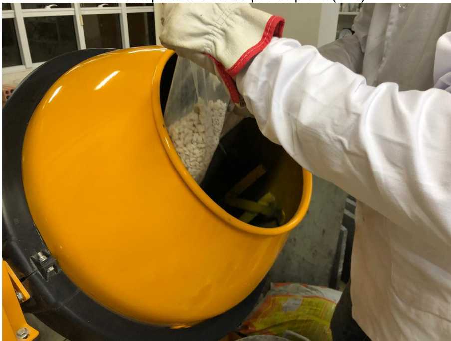
Figura 36 – Betoneira utilizada para mistura dos materiais de modo a formar a pasta de concreto utilizada para fazer os corpos de prova (CPs).
