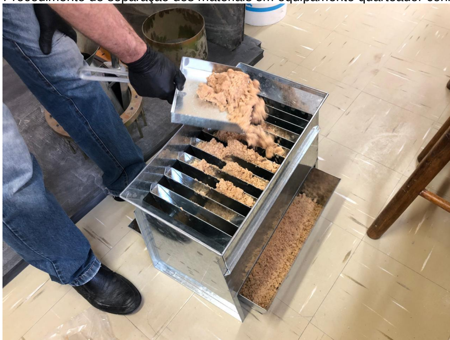
Figura 27 – Procedimento de separação dos materiais em equipamento quarteador conforme norma.
