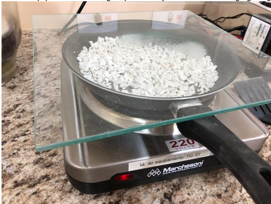
Figura 32 – Equipamento de secagem para remoção de umidade do agregado graúdo.
