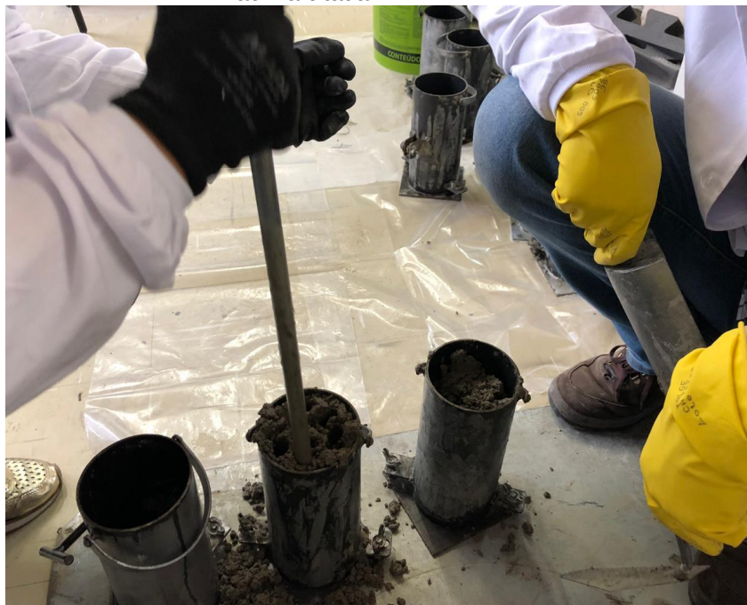
Figura 15 – Execução da moldagem dos CPs de acordo com a norma acima citada.
