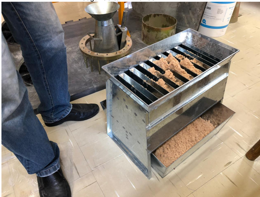
Figura 11 – Agregado miúdo sendo quarteado para a confecção dos CPs, segundo a NBR 5738
