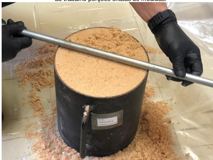
Figura 45 – Preparativos das quantidades de agregado miúdo antes da pesagem, de modo a conferir ao trabalho porções exatas de medidas.
