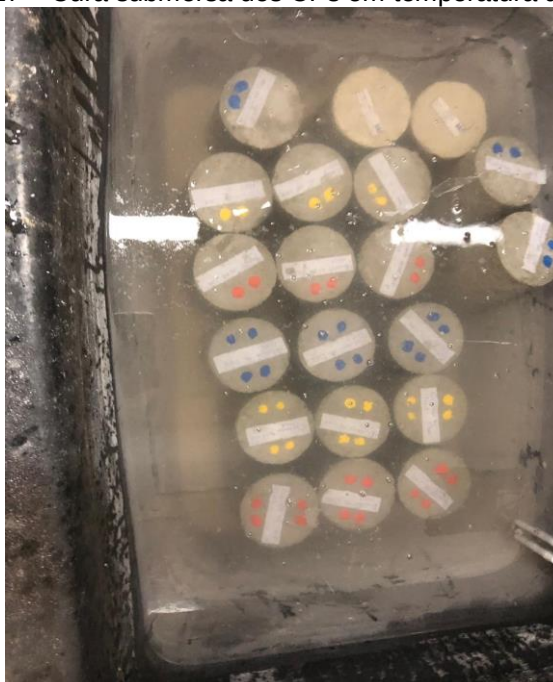
Figura 17 – Cura submersa dos CPs em temperatura de 22°C.
