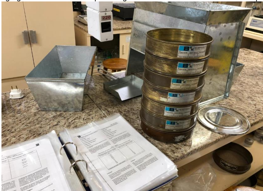
Figura 28 – Equipamentos, seleção de agregado miúdo através do quarteador, separação de grãos para agregado miúdo utilizando peneira granulométrica e normas utilizadas no processo.
