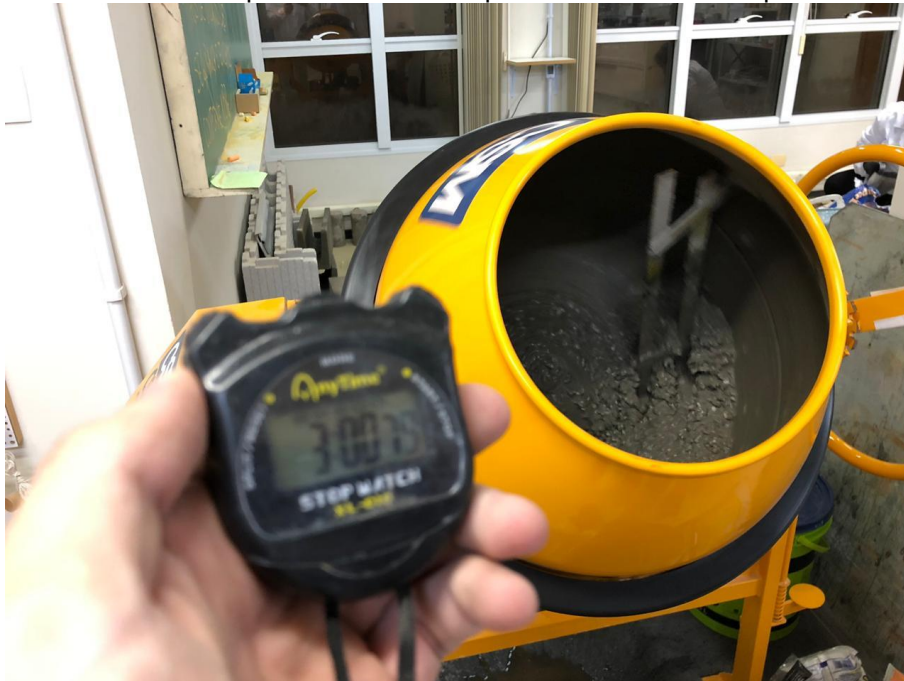
Figura 38 – Cronômetro para fiscalizar o tempo de mistura exato da pasta de concreto.
