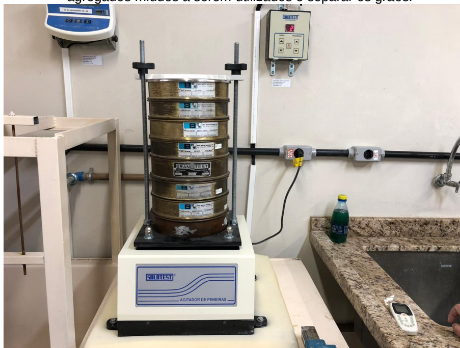
Figura 30 – Agitador de peneiras, de modo a vibrar a peneira granulométrica e assim selecionar os agregados miúdos a serem utilizados e separar os grãos.
