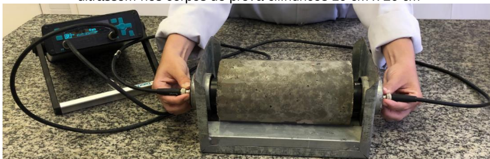
Figura 21 – Esquema do posicionamento dos transdutores para as medidas de velocidade de ultrassom nos corpos de prova cilíndricos 10 cm x 20 cm
