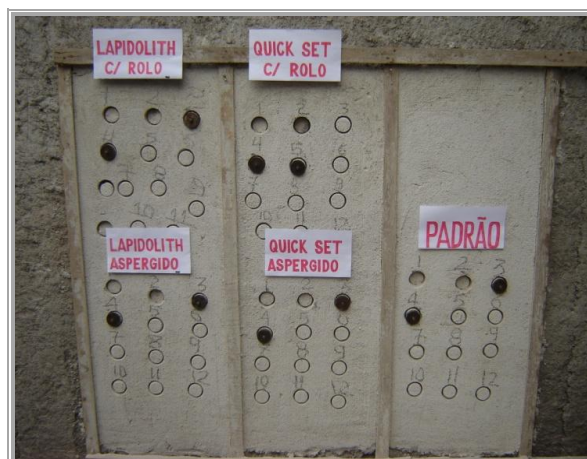
Foto 10 - Distribuição dos corpos de prova para o ensaio de resistência à tração.
