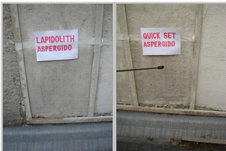
Foto 9 – Vista dos painéis 3 e 4, onde foram aplicados através de aspersão por meio de espargidor do tipo agrícola, os endurecedores de superfície: Lapidolith - fluorsilicato de magnésio (a) e Quickset – silicato de cálcio (b).
