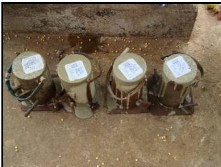
Foto 33 – Moldagem de corpos de prova
