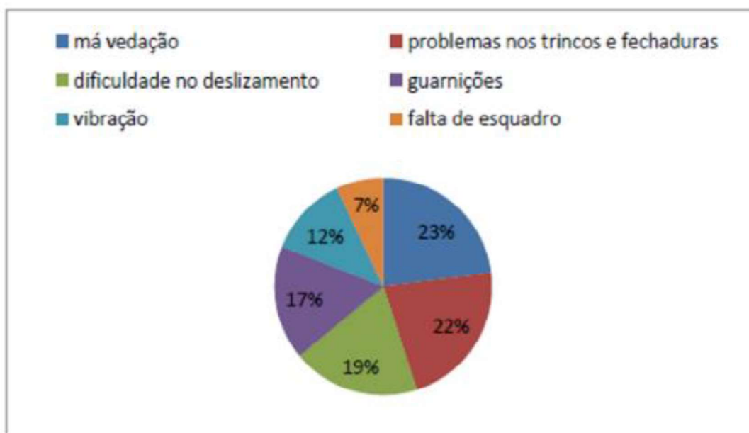
Figura 7: Distribuição de defeitos em esquadrias Fonte: SOUZA, 2018
