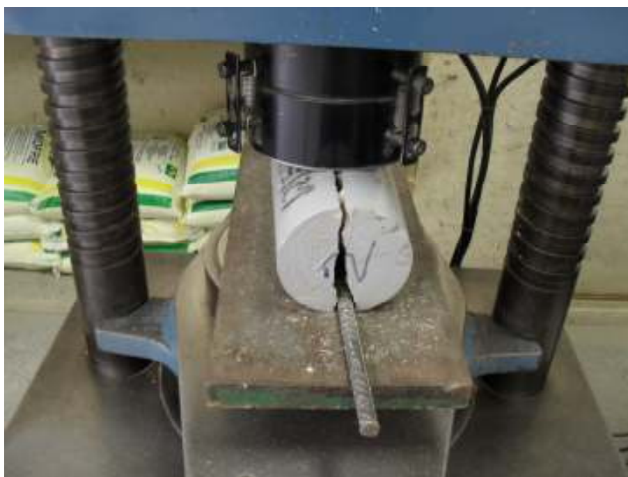
Foto 20. Corpos de prova “rompidos” para avaliação do perfil de absorção interna.
