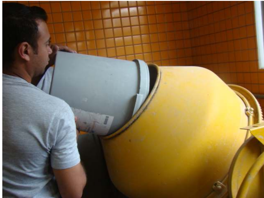
Foto 1. Mistura dos materiais na betoneira.
