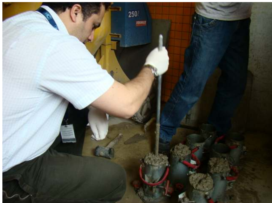
Foto 4. Moldagem dos corpos de prova.
