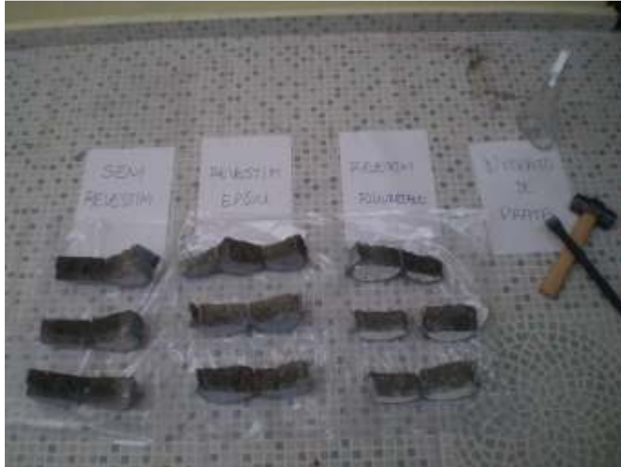
Foto 12. Amostras fraturadas para execução do ensaio de determinação da frente de penetração de cloretos, através da aspersão de solução de nitrato de prata.
