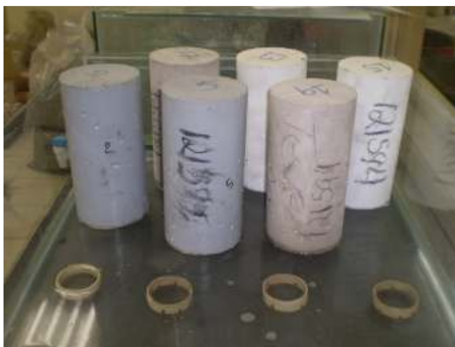
Foto 19. Corpos de prova no “aquário” para ensaio de capilaridade.
