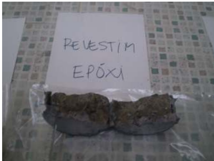
Foto 14. Medição da camada de penetração de cloretos, na amostra com sistema de proteção em epóxi, onde observa-se penetração de cloretos em pites .
