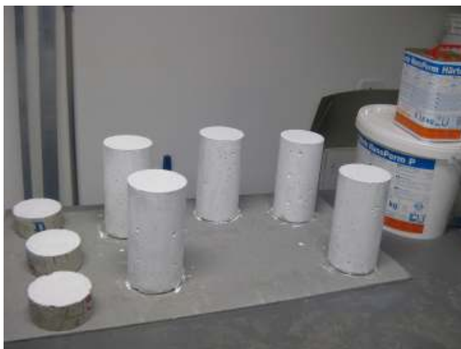
Foto 11. Corpos de prova com sistema de proteção aplicado.
