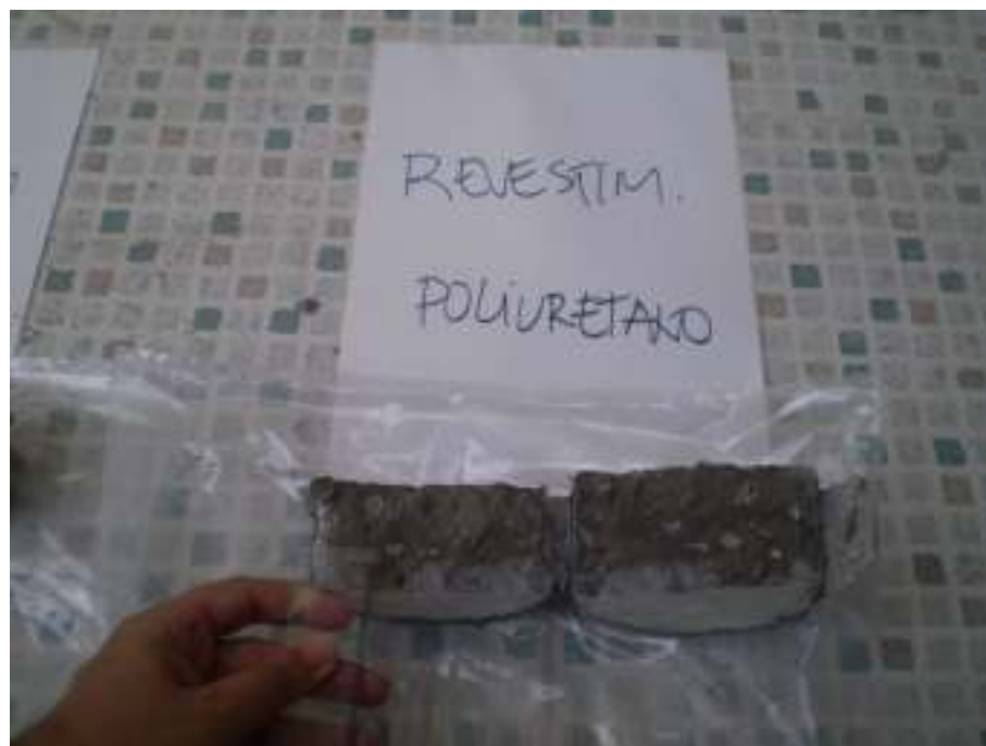
Foto 15. Medição da camada de penetração de cloretos, na amostra com sistema de proteção em poliuretano, onde observa-se penetração de cloretos em pites .
