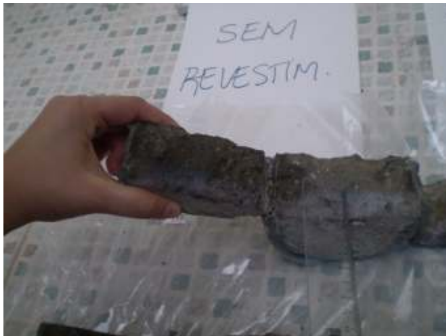
Foto 13. Medição da camada de penetração de cloretos, na amostra de referência (sem proteção), onde observa-se camada uniforme de penetração de cloretos.
