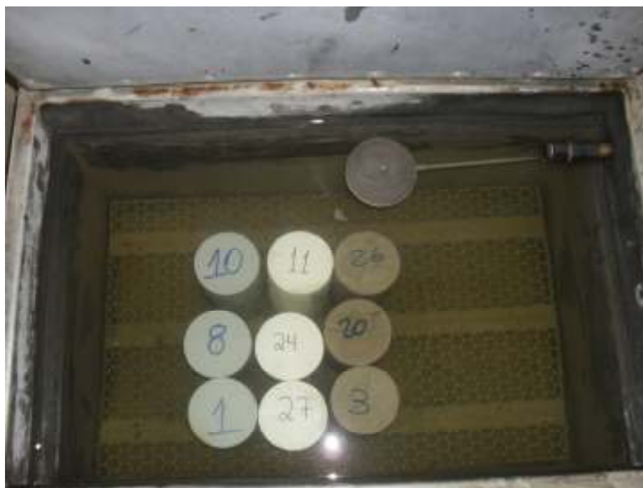
Foto 16. Corpos de prova imersos em fervura.
