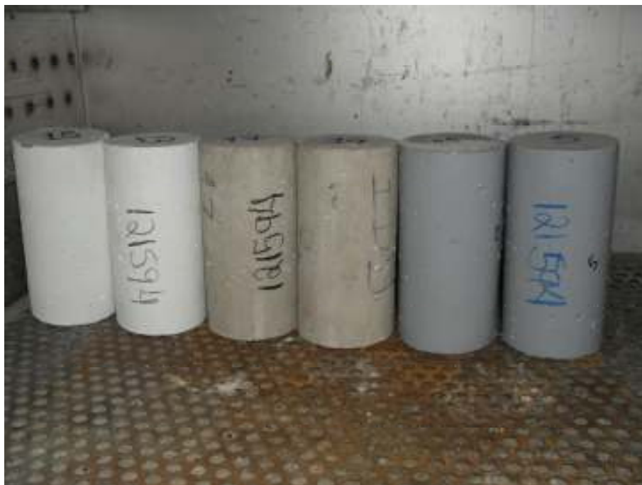
Foto 18. Corpos de prova no interior da estufa.
