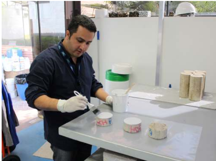
Foto 8. Aplicação de pintura nas fatias preparadas para o ensaio de migração de cloretos.
