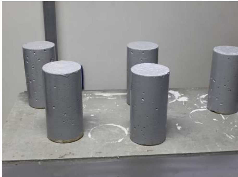
Foto 9. Corpos de prova preparados para os ensaios com sistema de proteção em epóxi.
