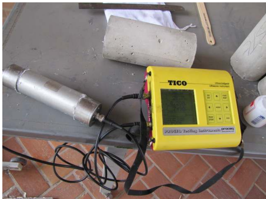
Foto 7. Calibração do equipamento pela barra de referência do ultrassom.
