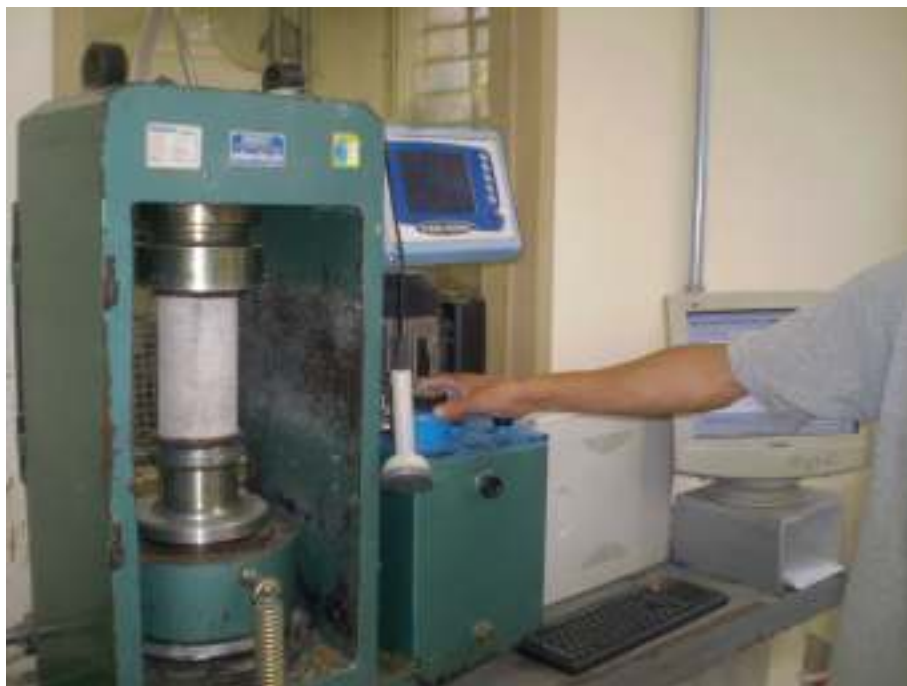
Foto 5. Ensaio de resistência à compressão axial – Caracterização das amostras.
