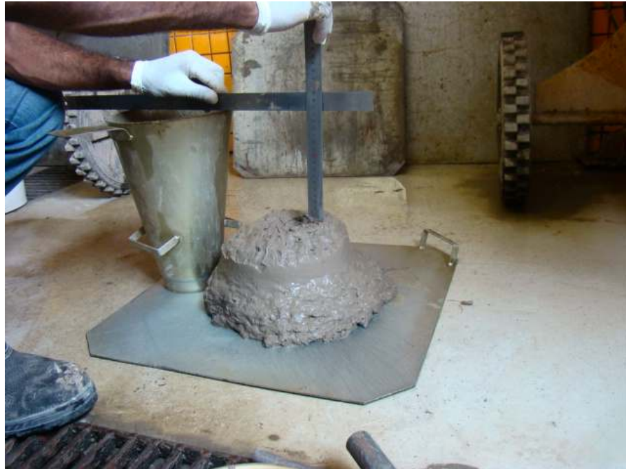
Foto 3. Execução do ensaio de abatimento de tronco de cone “Slump test”.
