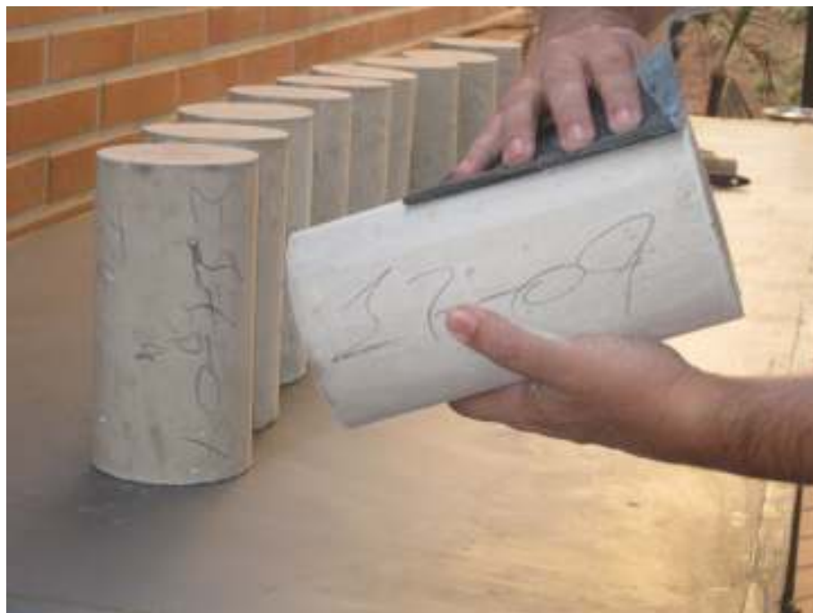
Foto 10. Lixamento da superfície para preparação do substrato para aplicação do sistema de proteção.
