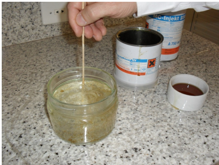
Figura 3 – Colocação da Resina em contato com água.
