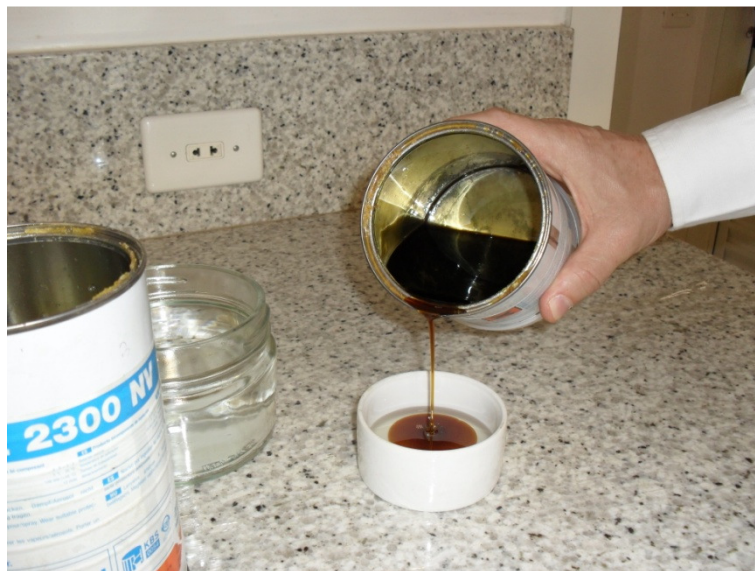
Figura 5 – Mistura do Catalisador ( componente B ) à Resina de Poliuretano ( componente A ) – Amostra 2
